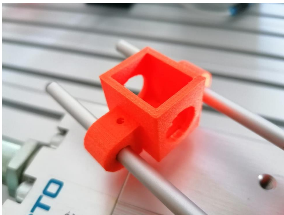
Slika 8.7 Košarica za radne komade
