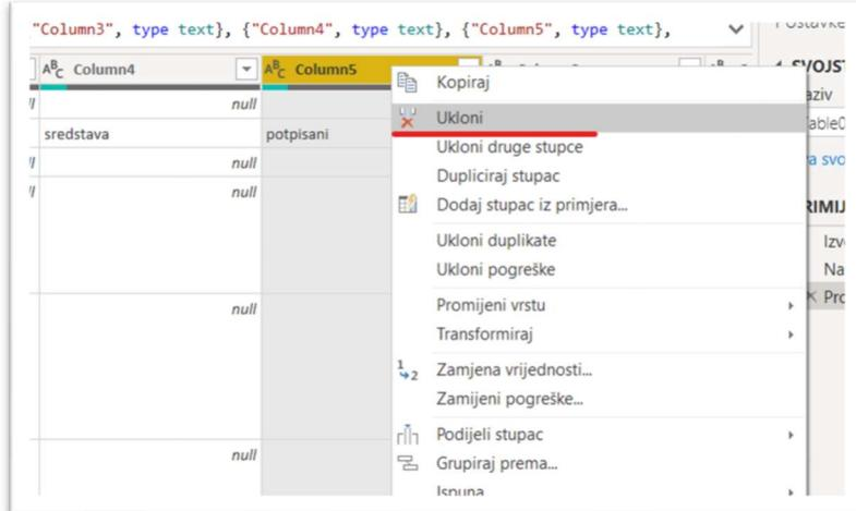
Slika 25: Brisanje cijelog stupca iz tablice
