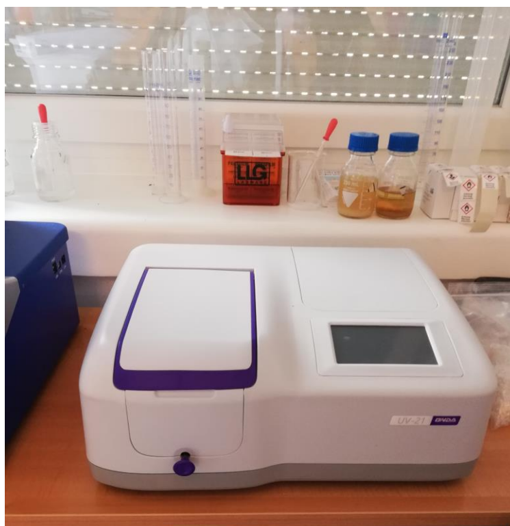
Slika 9. spektrofotometar, UV/Visible Spectrophotometer 195-1050 nm, 4 nm bandwidth, Italija
