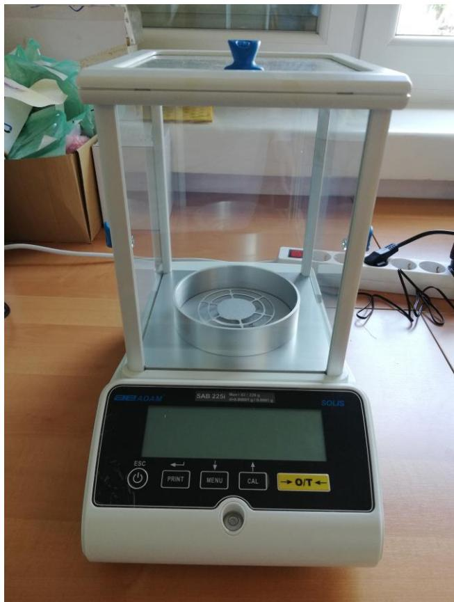
Slika 10. analitička vaga, KERN & SOHN GmbH, Njemačka
