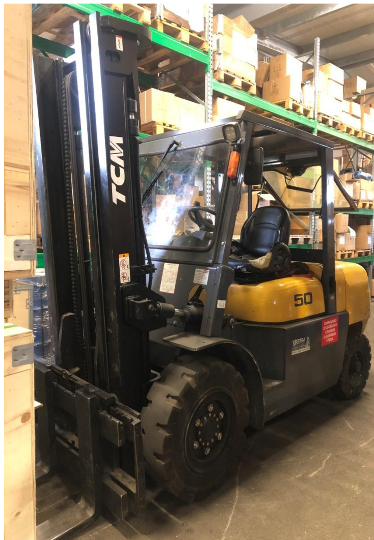
Slika 20: Viličar s motorom na unutarnje izgaranje
