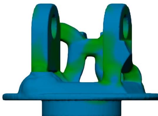
Slika 82 – Prikaz modela prihvata palca nastalog postupkom generativnog dizajna s prikazanim napreznjima
