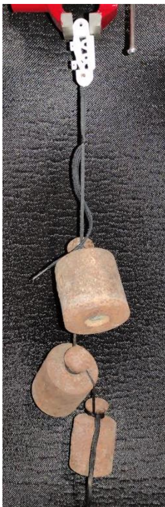
Slika 98 – Opterećenje od 50 N u smjeru slaganja slojeva
