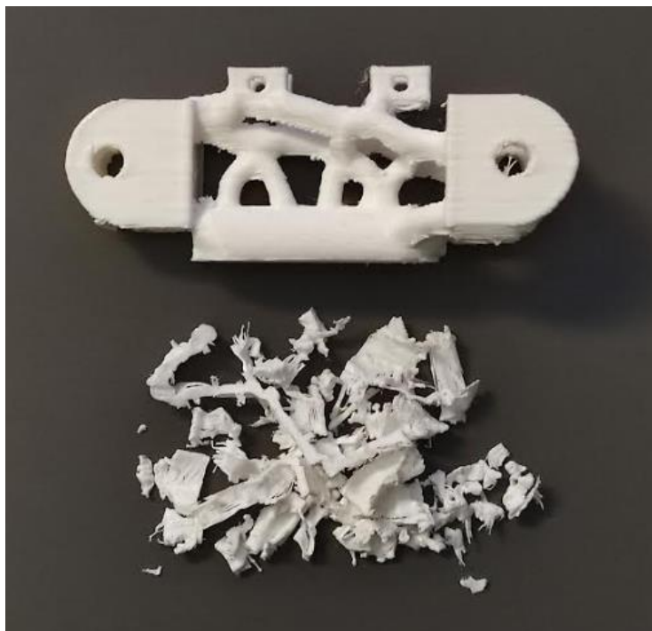
Slika 91 – Gotov prototipni model članka prsta (gore) te odvojeni potporni materijal
