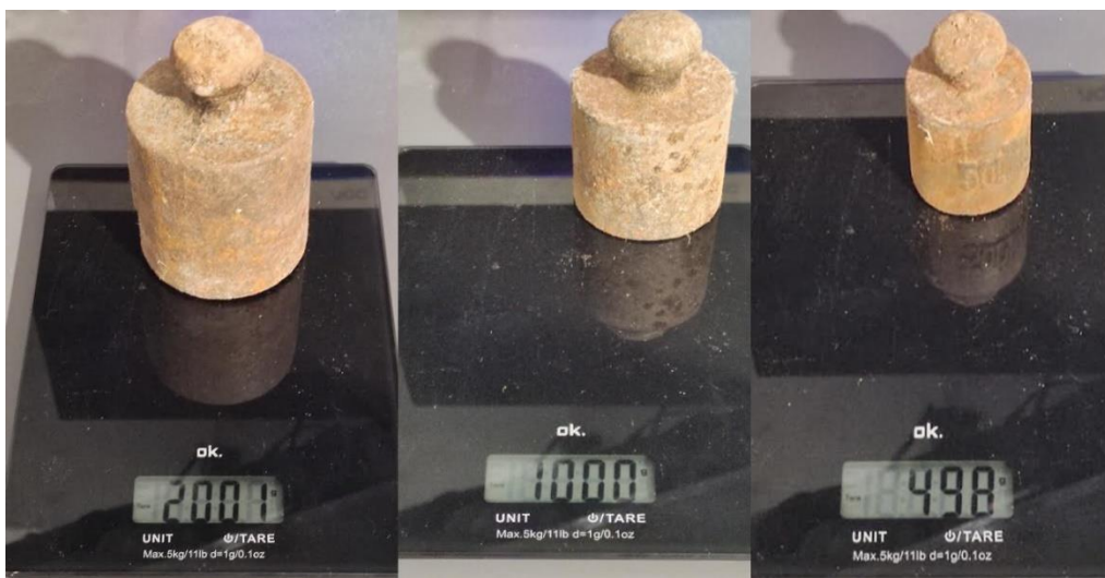
Slika 97 – Izmjerene vrijednosti utega koji će se koristiti za statičko ispitivanje izrađenog modela
