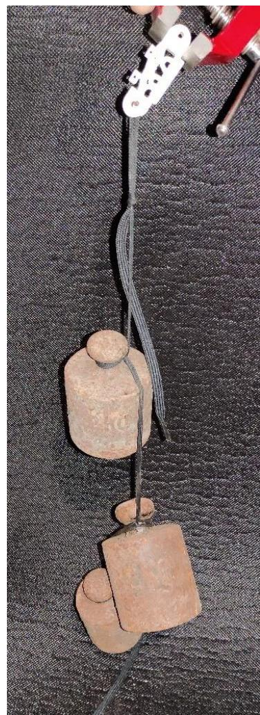
Slika 100 - Opterećenje od 50 N pod kutom  $45^\circ$  na smjer slaganja slojeva
