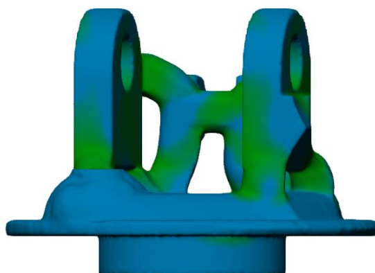
Slika 82 – Prikaz modela prihvata palca nastalog postupkom generativnog dizajna s prikazanim naprežanjima
