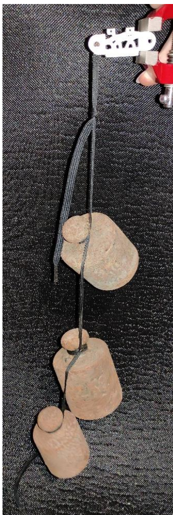
Slika 99 - Opterećenje od 50 N u smjeru okomitom na slaganje slojeva
