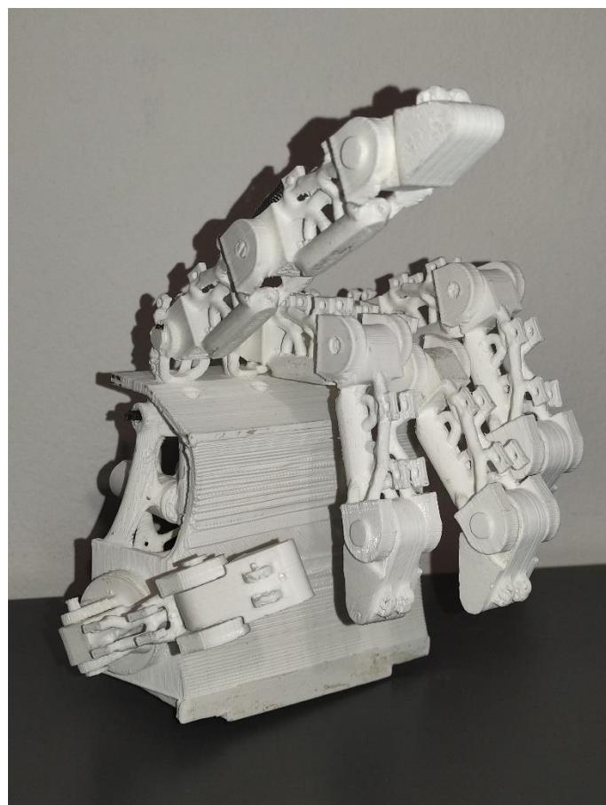
Slika 103 – Gotov prvi, funkcionalni, prototipni model bioničke šake
