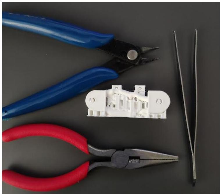
Slika 90 – Izradak te pribor za odvajanje potpornih dijelova nastalih tokom printa
