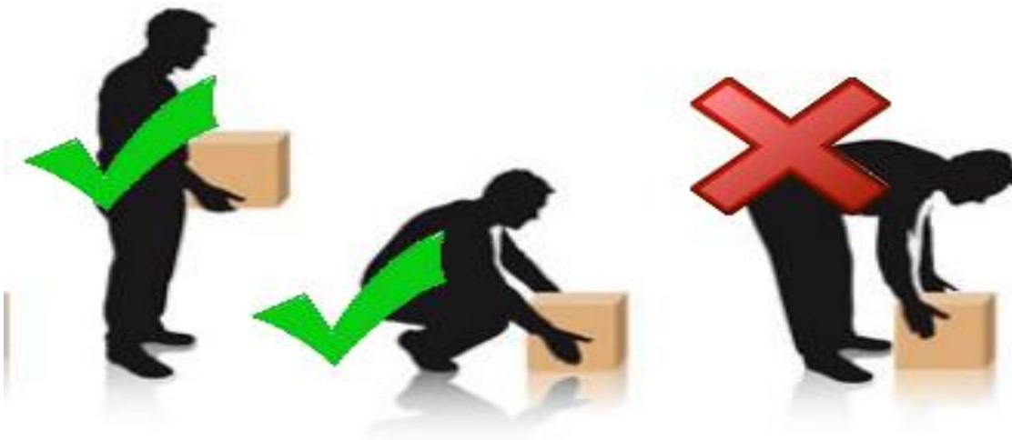
Slika 6.7.2. Prikaz pravilnog podizanja tereta
