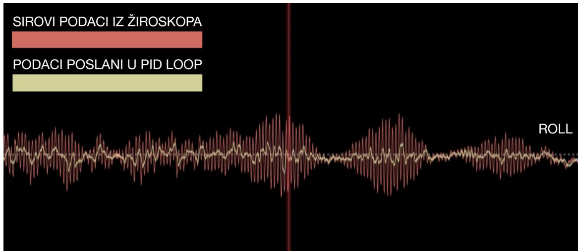
Slika 2.15: BlackBox log prikaz sirovih i filtriranih podataka
