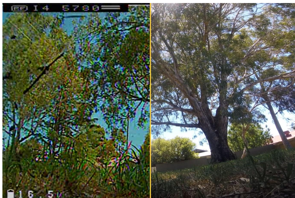
Slika 2.14: Analogni prijenos (lijevo) uspoređen s DJI digitalnim prijenosom (desno)
