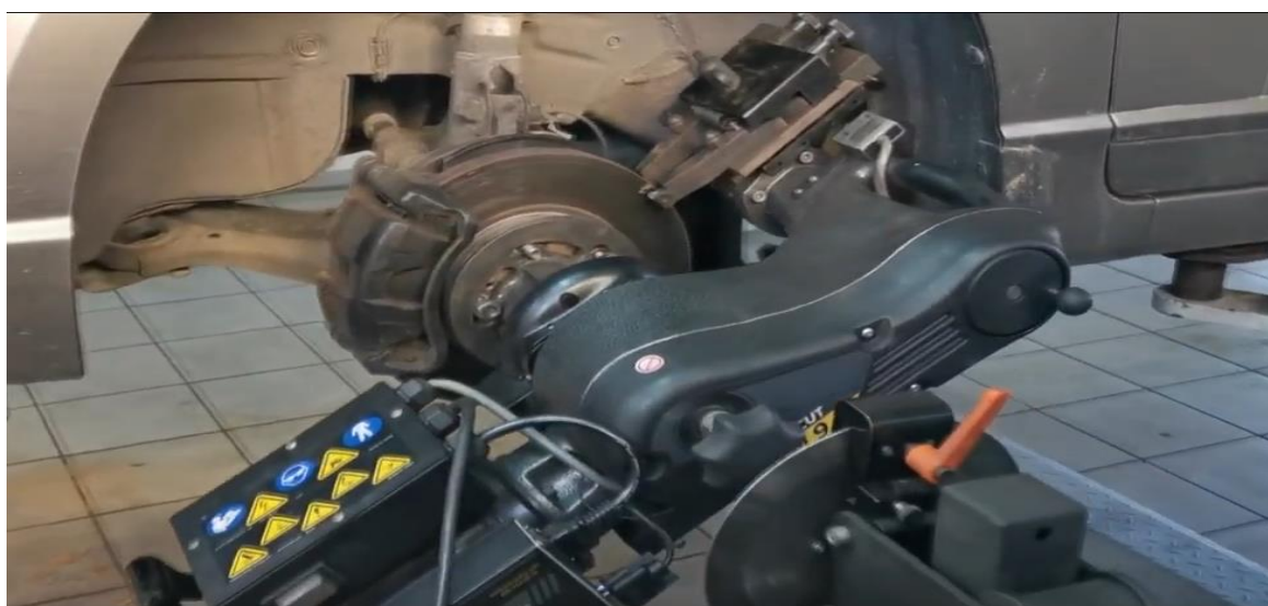
Slika 4.11 Tokarenje diska s tokarskim strojem s dva noža [30]
