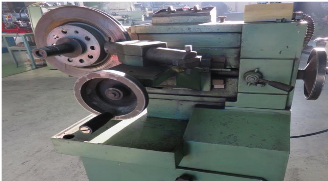
Slika 4.10 Tokarenje kočionog diska na normalnom stroju
