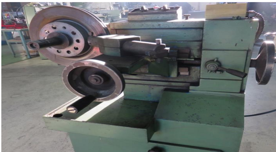
Slika 4.10 Tokarenje kočionog diska na normalnom stroju
