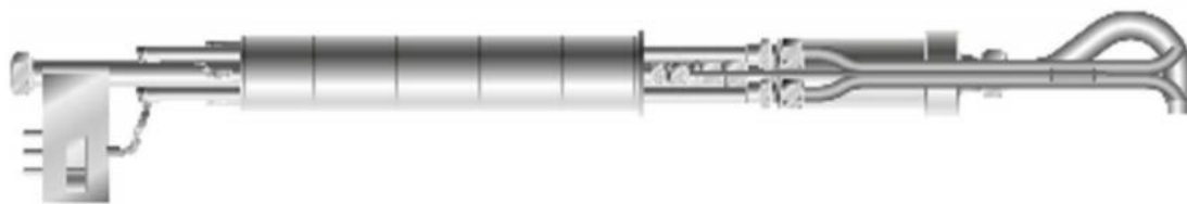
Slika 14. Negrijana sonda s držačem filtra [22]
