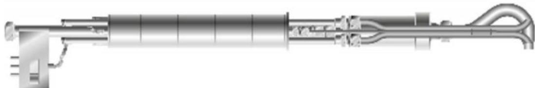
Slika 14. Negrijana sonda s držačem filtra [22]
