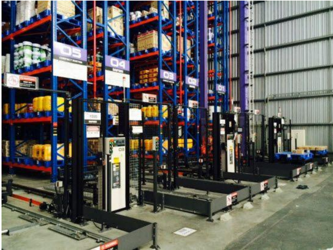
Slika 25: Prikaz jednog uređaja AS/RS sustava po kanalu
