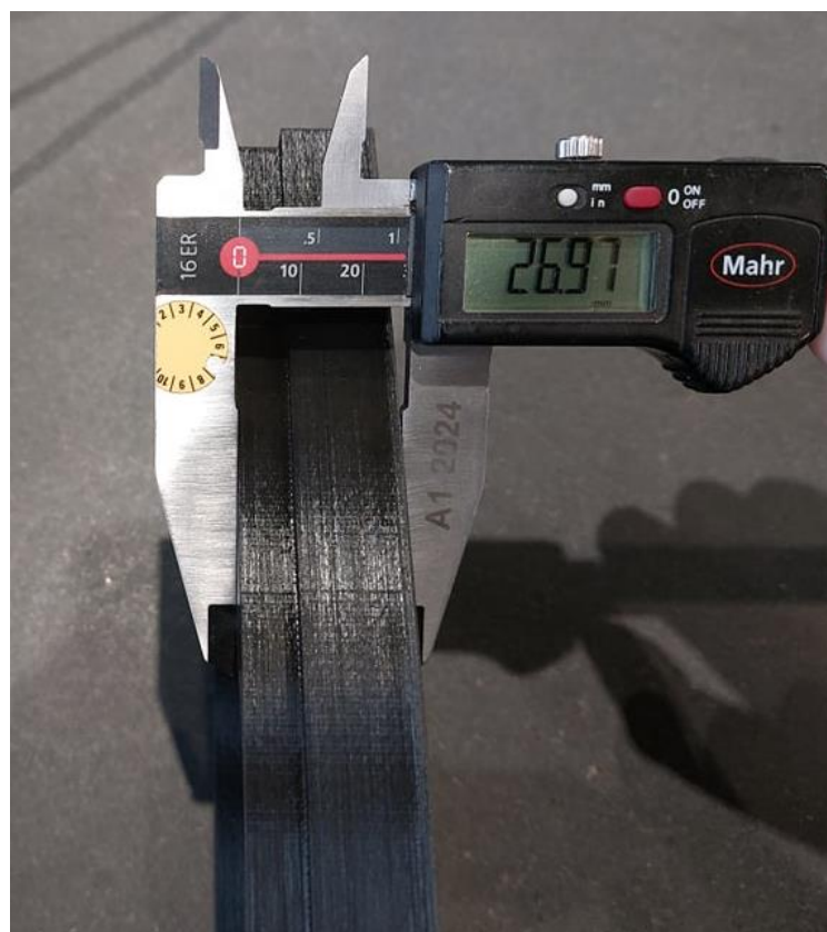
Slika 5.3 Mjerenje vanjske dimenzije; nazivna mjera 27 mm [izvor: rad autora]
