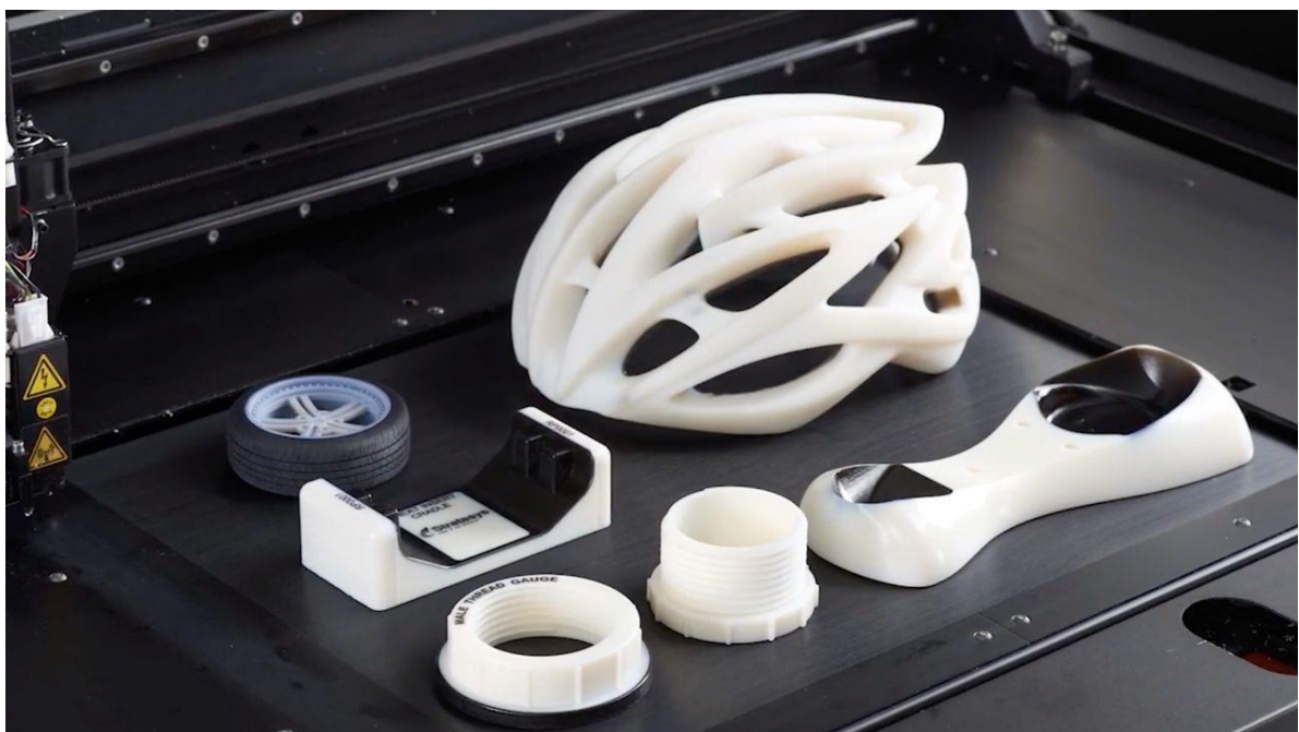
Slika 2.9 Proizvodi izrađeni PolyJet tehnologijom[9]
