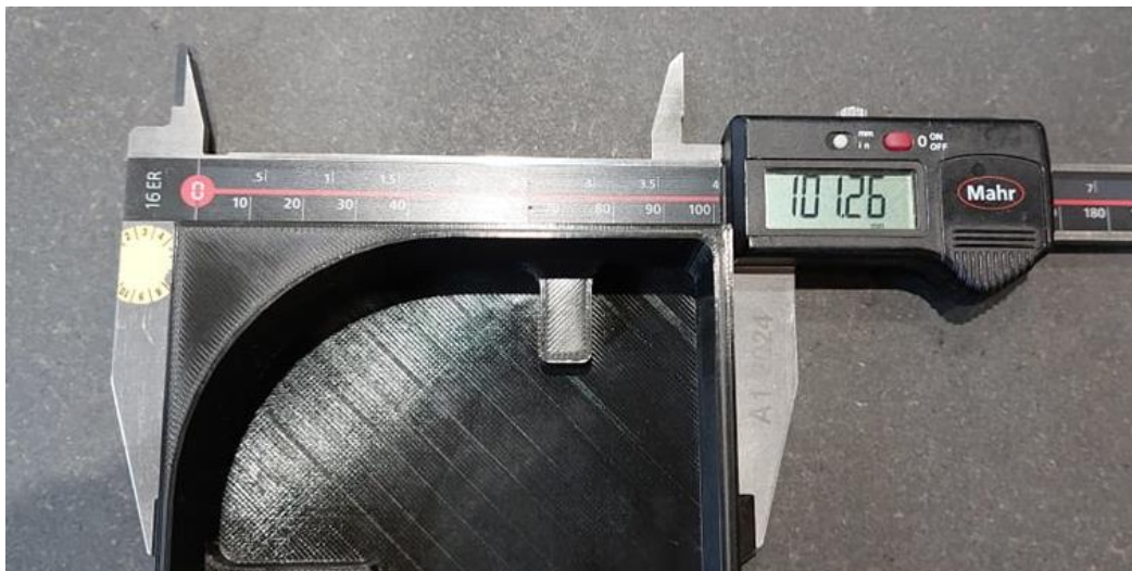
Slika 5.2 Mjerenje vanjske dimenzije; nazivna mjera 101 mm [izvor: rad autora]
