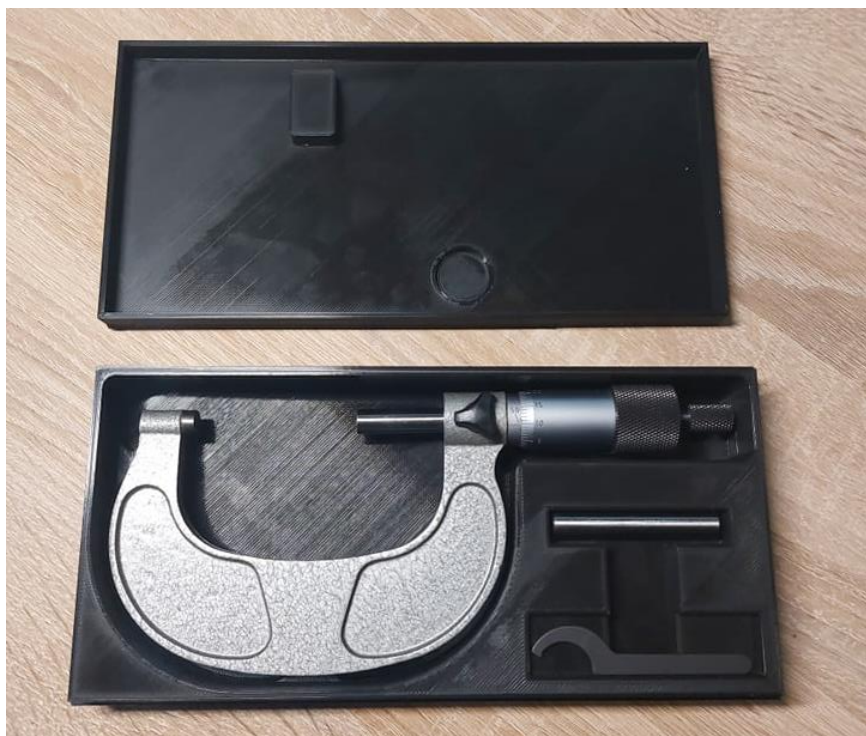
Slika 4.10 Mikrometar u ambalaži izrađenom FDM 3D printerom [izvor: rad autora]
