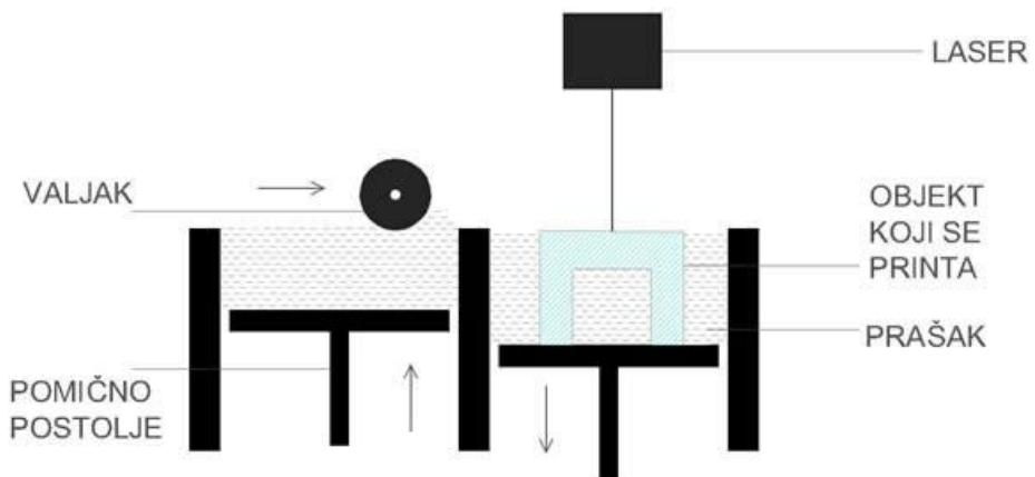
*Slika 2.4 Shematski prikaz SLS tehnologije[5]*
