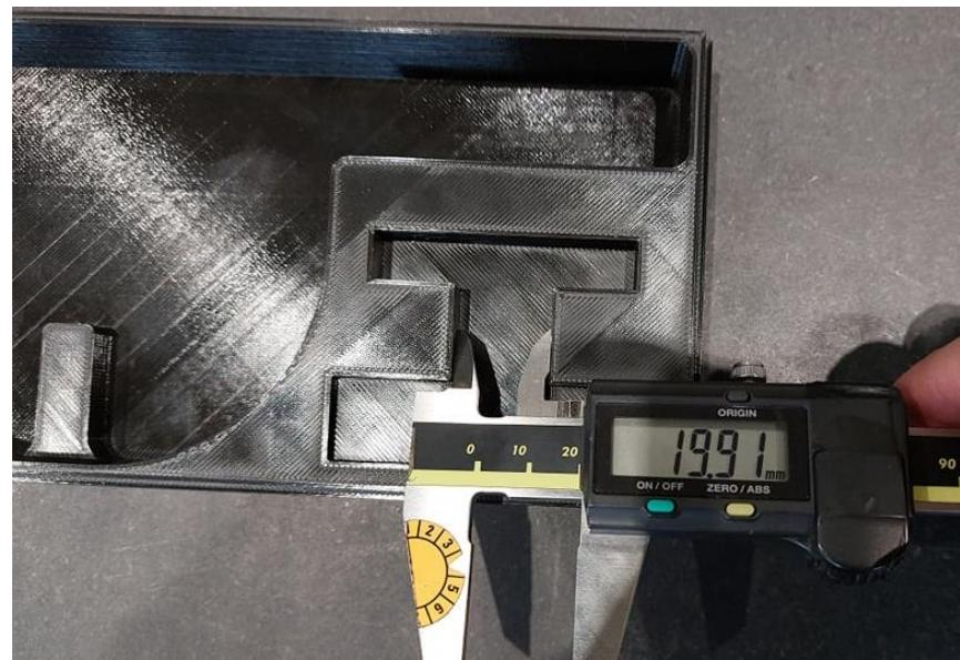
Slika 5.4 Mjerenje unutarnje dimenzije; nazivna mjera 20 mm [izvor: rad autora]
