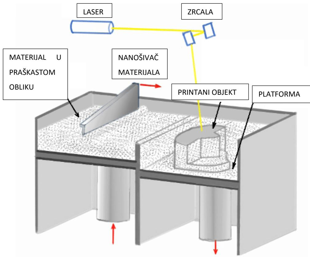
Slika 2.10 Shematski prikaz DMLS tehnologije[11]
