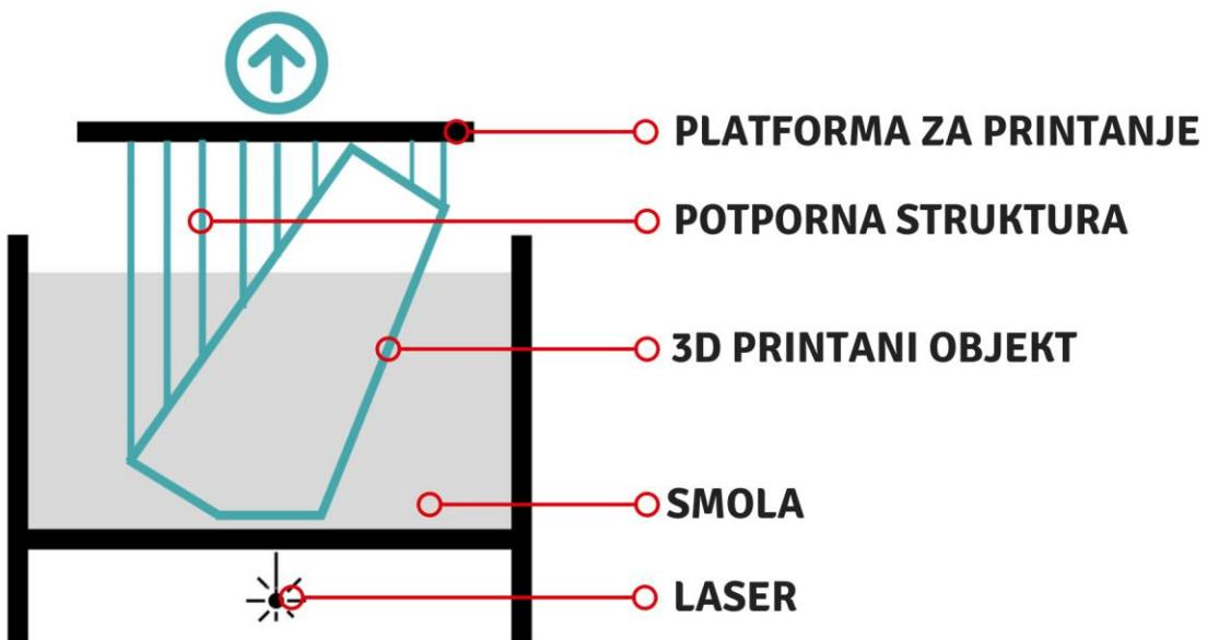
*Slika 2.3 Shematski prikaz SLA postupka[4]*
