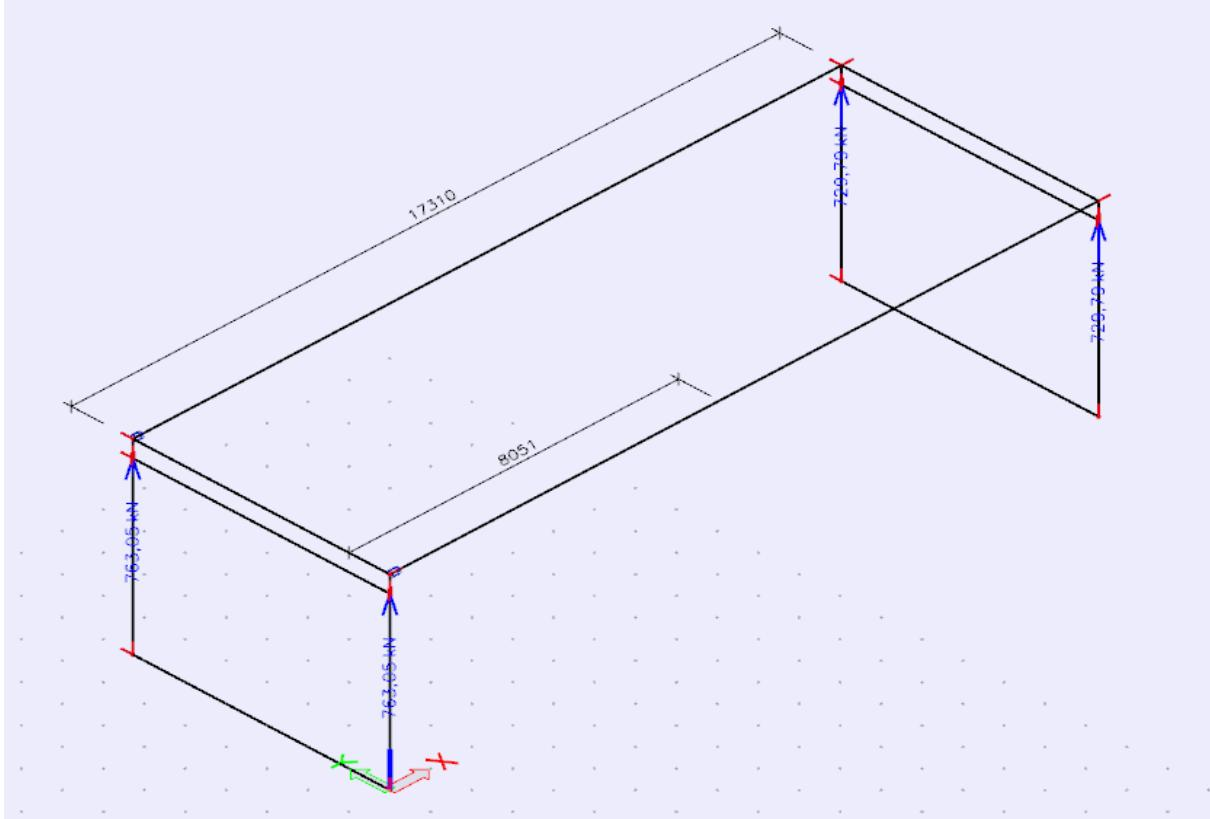
Slika 29. Reakcije stalnog opterećenja
