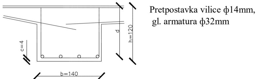
Slika 34. Prikaz određivanja staticke visine
