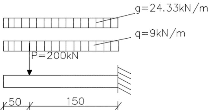
Slika 41. Prikaz konzolnog nosača
