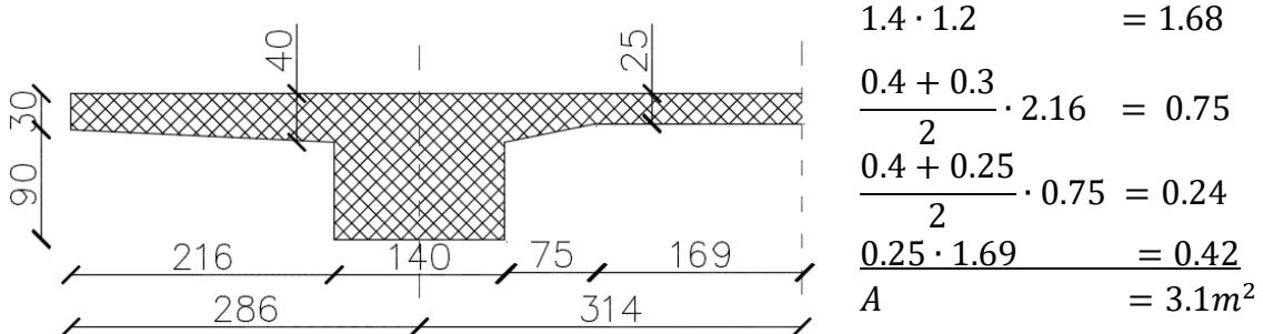
Slika 4. Prikaz rebrastog nosača u poprečnom presjeku
