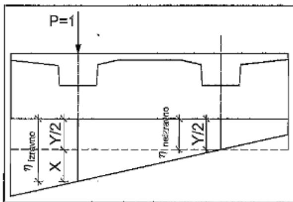
Ako je X vrijednost koja se prenosi savijanjem izravnog opterećenja nosača, a Y je dio utjecaja koji se preraspodjeljuje na oba nosača zbog torzijske krutosti presjeka vrijedi:
