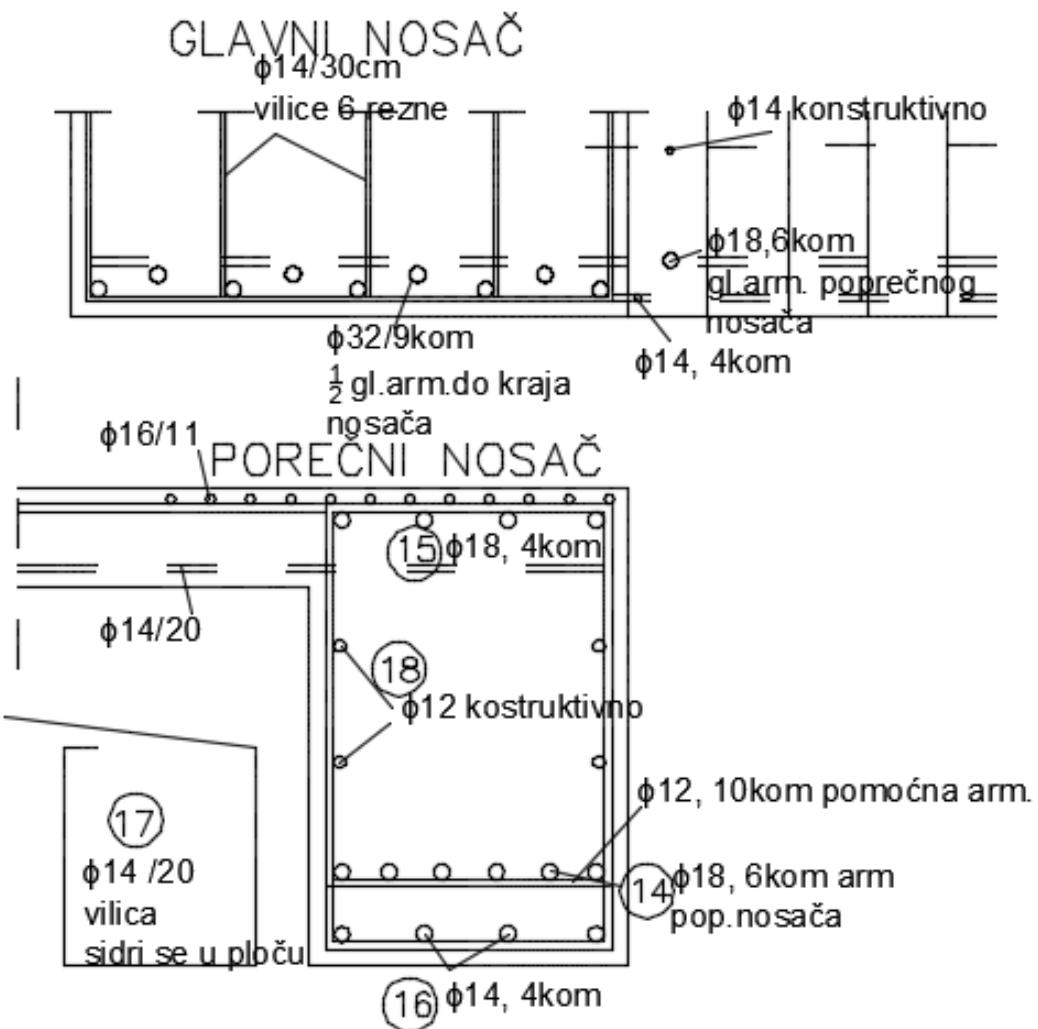
Slika 43. Prikaz presjeka na rubu nosač + poprečni nosač
