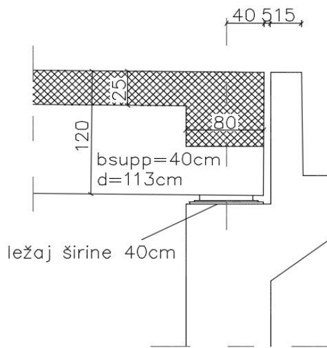
Slika 36. Prikaz detalja mosta nad ležajem
