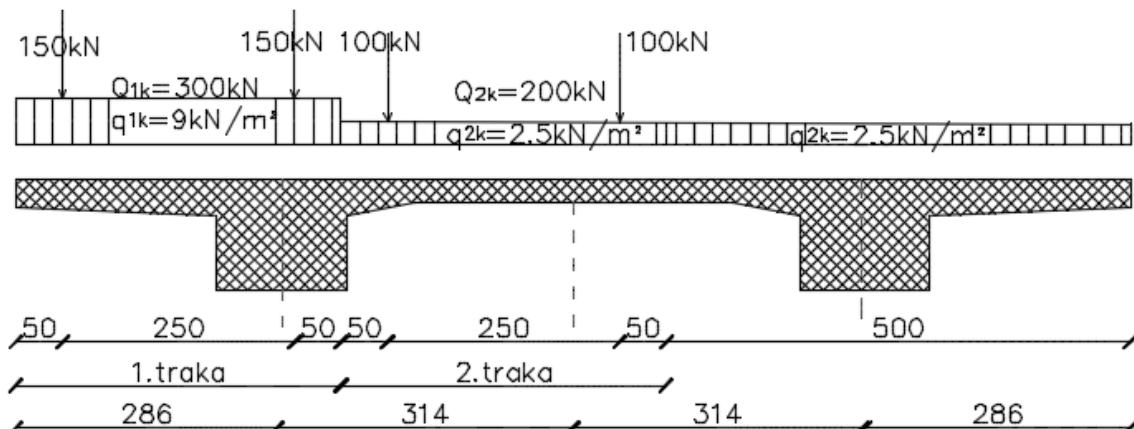
Slika 5. Prikaz prometnog opterećenja na poprečni presjek
