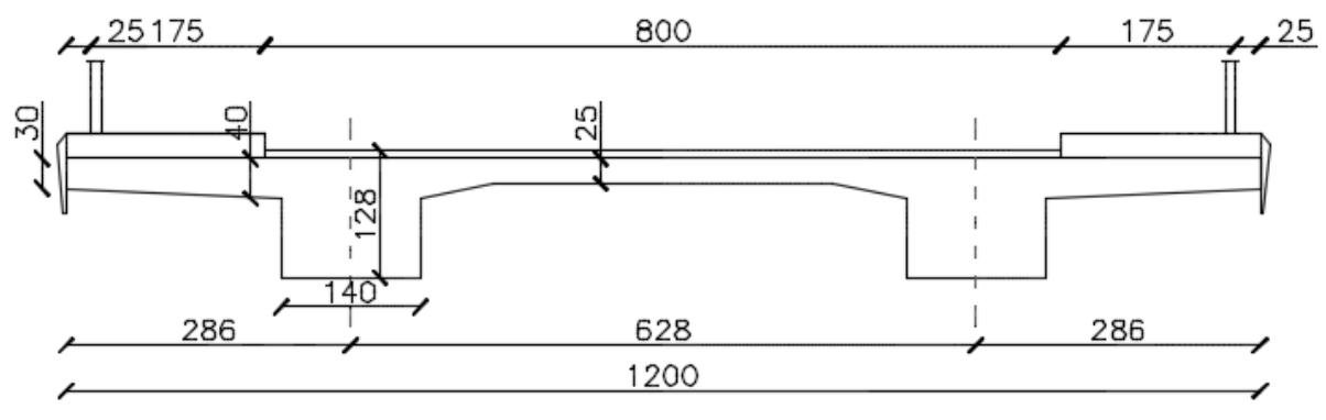
Slika 3. Poprečni presjek nadvožnjaka
