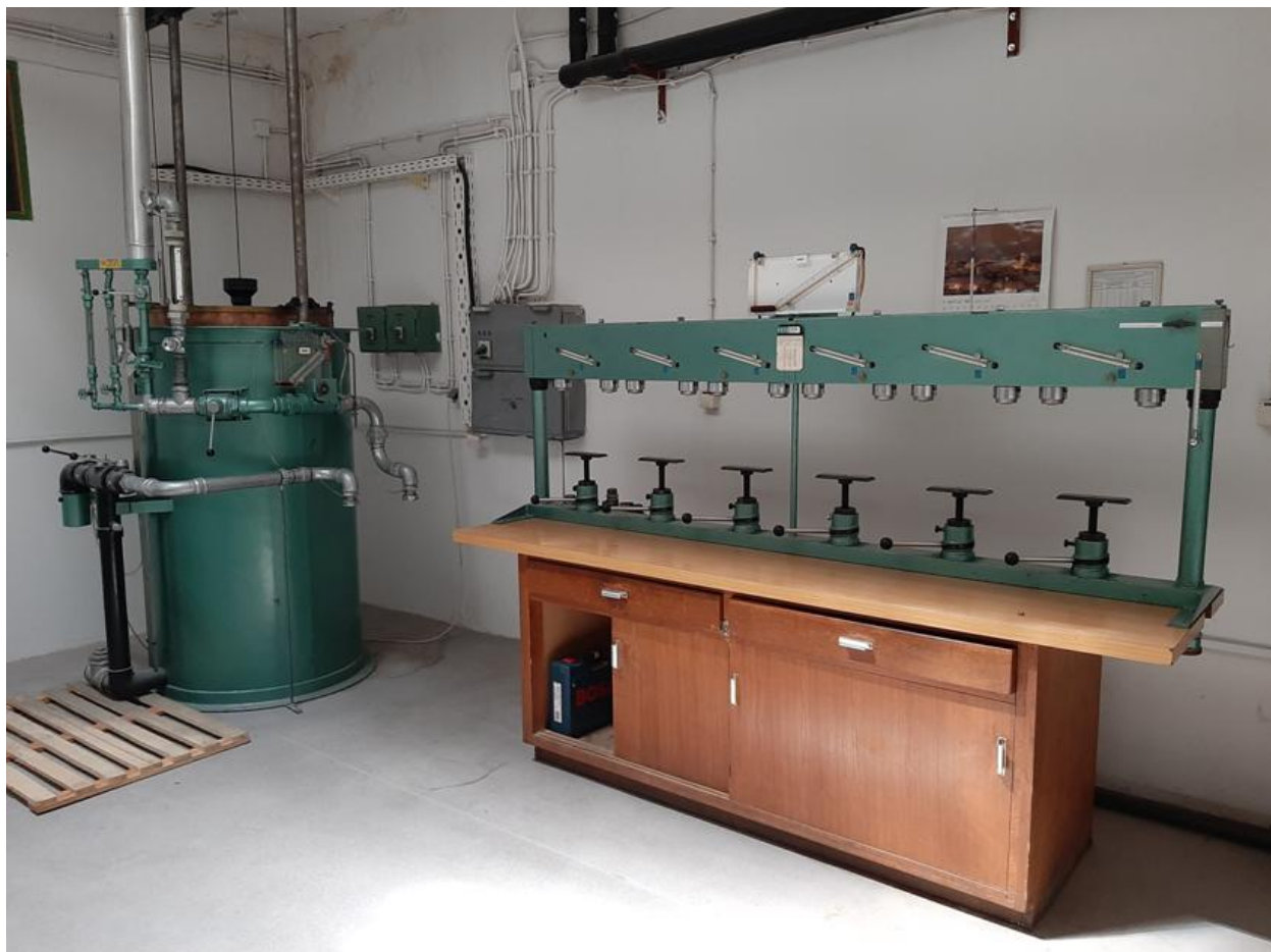
Slika 17. Uređaj sa zvonom za ispitivanje plinomjera (fotografirano 30.6.2021.)
