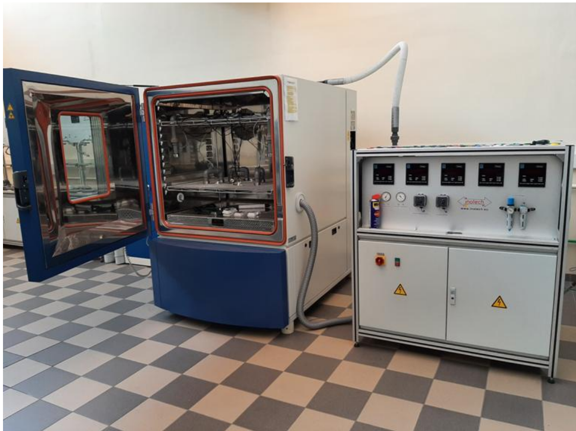
Slika 19. Ispitni uređaj s kritičnim sapnicama i temperaturnom komorom – Ispitna linija 2 (fotografirano 30.6.2021.)
