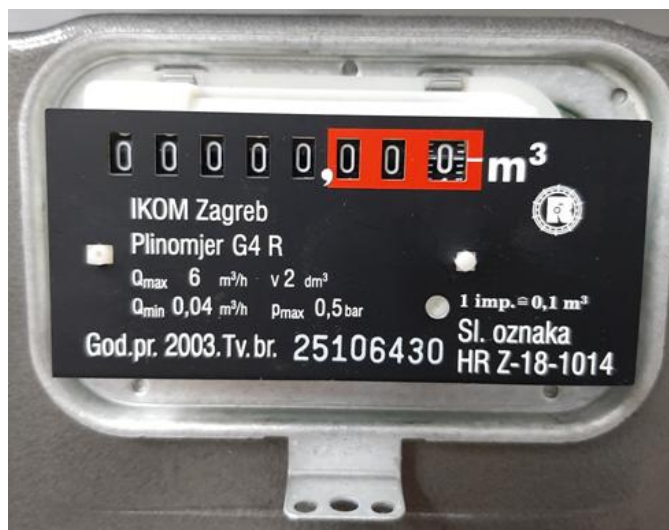
Slika 21. Natpisna pločica G4 plinomjera (fotografirano 27.8.2021.)
