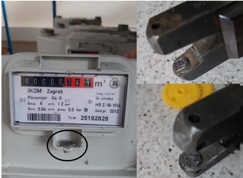
Slika 43. Ovjerna oznaka na plinomjeru i kliješta za utiskivanje ovjerne oznake s osnovnim i godišnjim ovjernim žigom (fotografirano 1.9.2021.)
