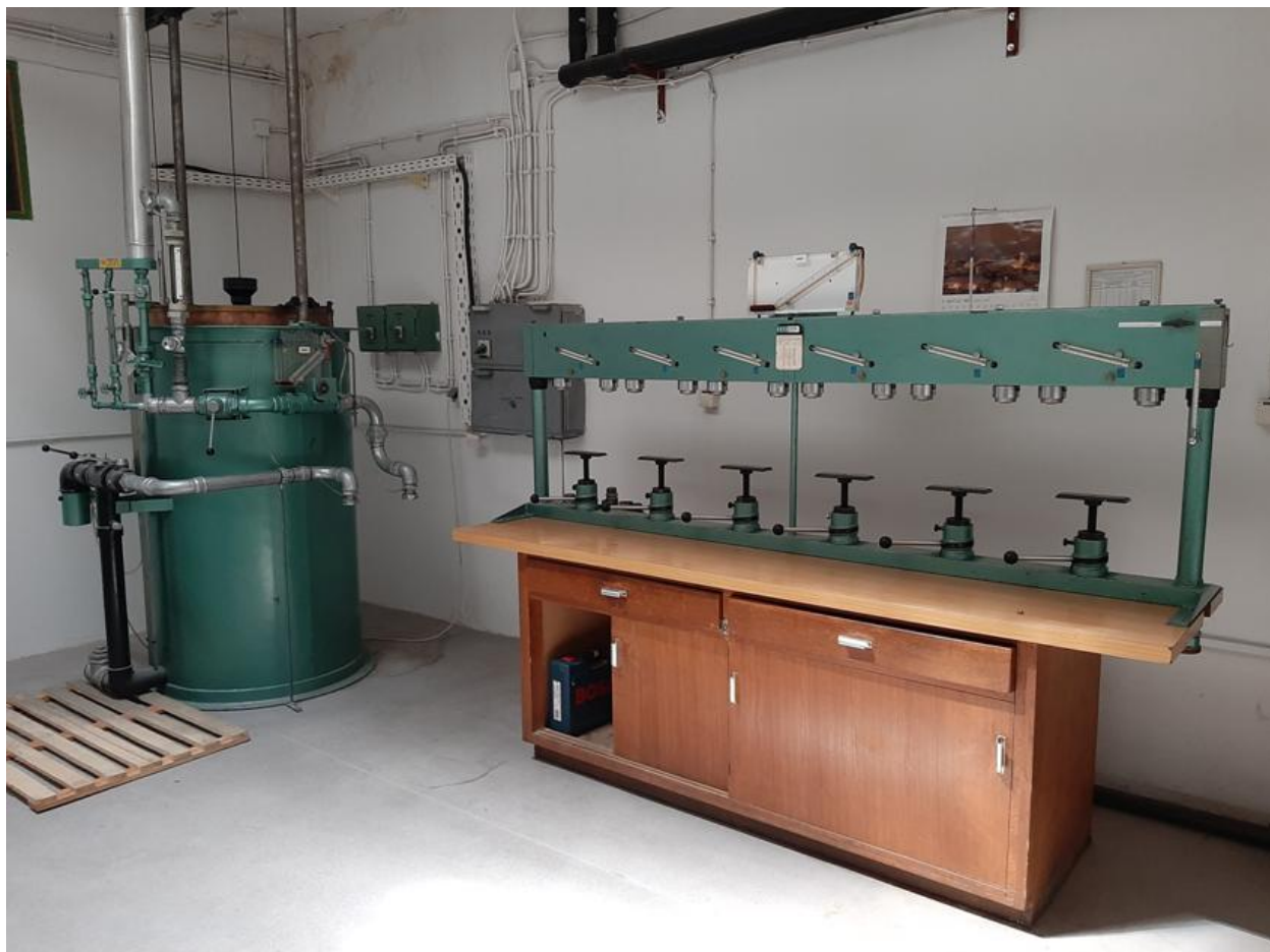
Slika 17. Uređaj sa zvonom za ispitivanje plinomjera (fotografirano 30.6.2021.)
