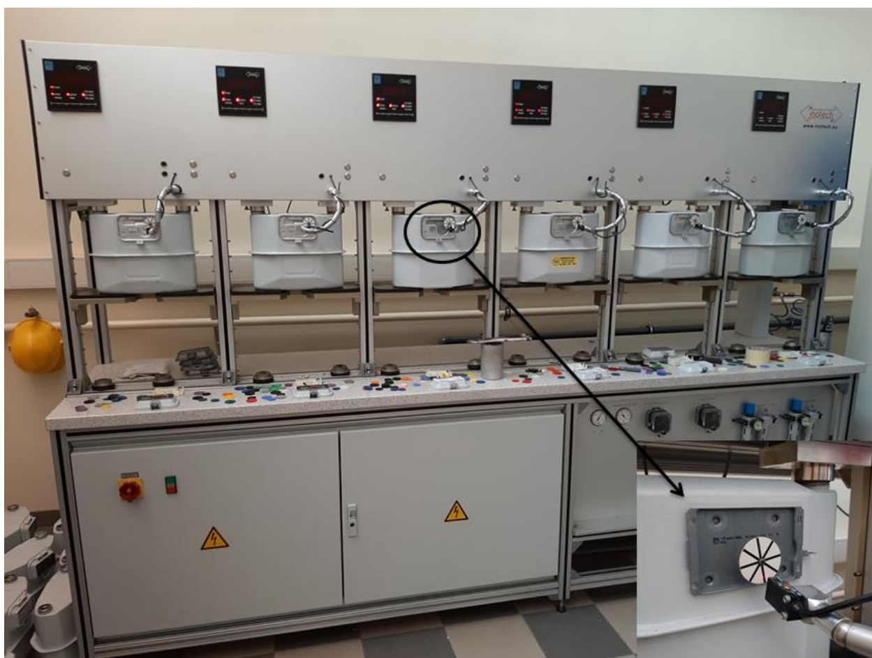
Slika 22. Plinomjeri G4 montirani na ispitnoj liniji (fotografirano 30.8.2021.)
