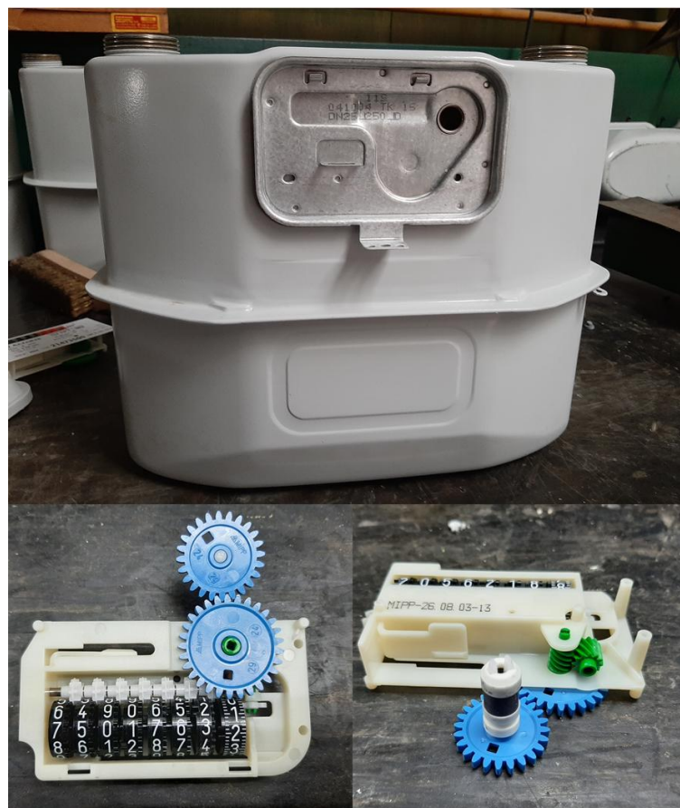
Slika 34. Prikaz plinomjera, magnetne spojke, para zupčanika i brojčanika (fotografirano 15.9.2021.)
