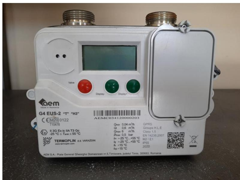
Slika 8. Ultrazvučni plinomjer G4 EUS-2 (fotografirano 3.8.2021.)
