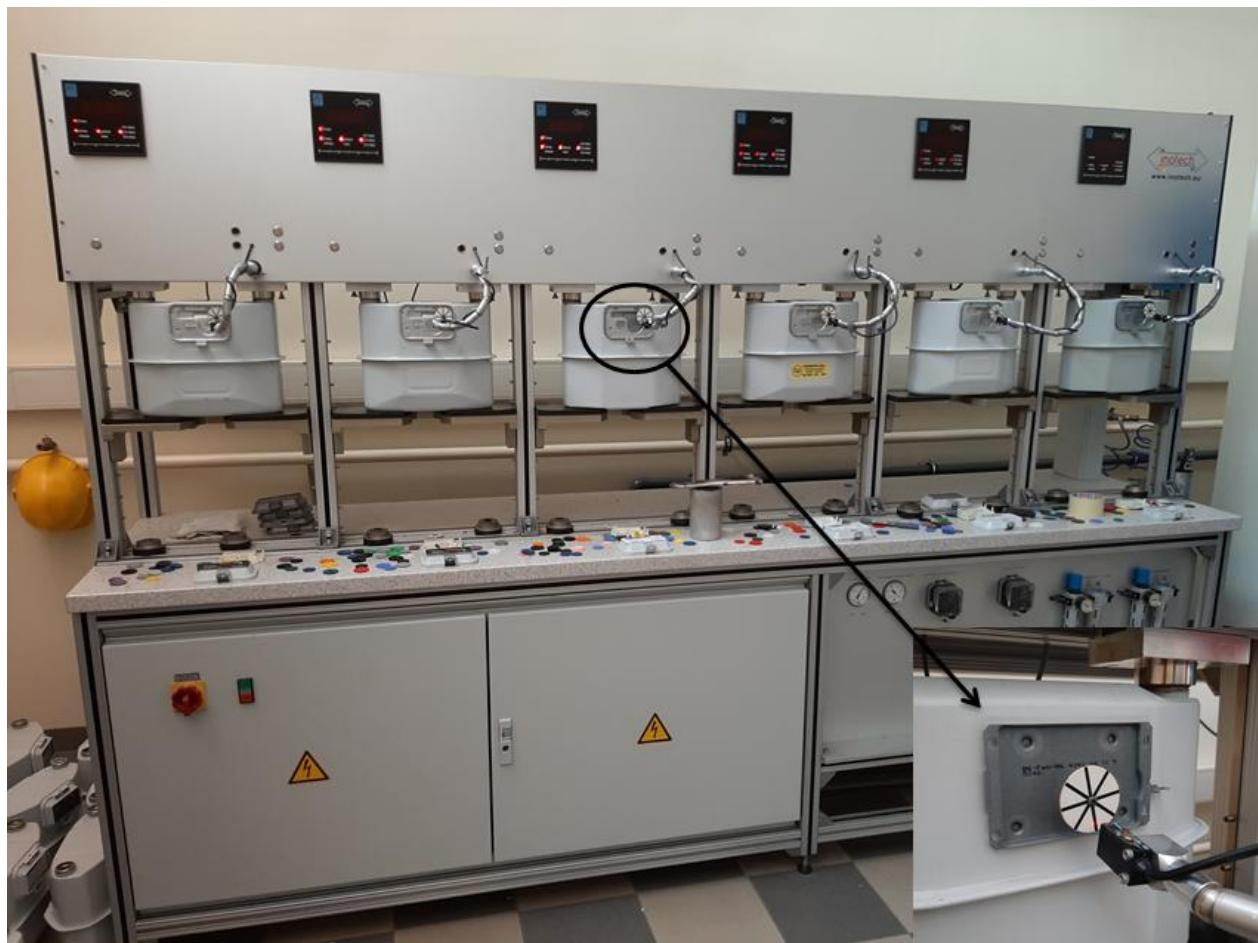
Slika 22. Plinomjeri G4 montirani na ispitnoj liniji (fotografirano 30.8.2021.)
