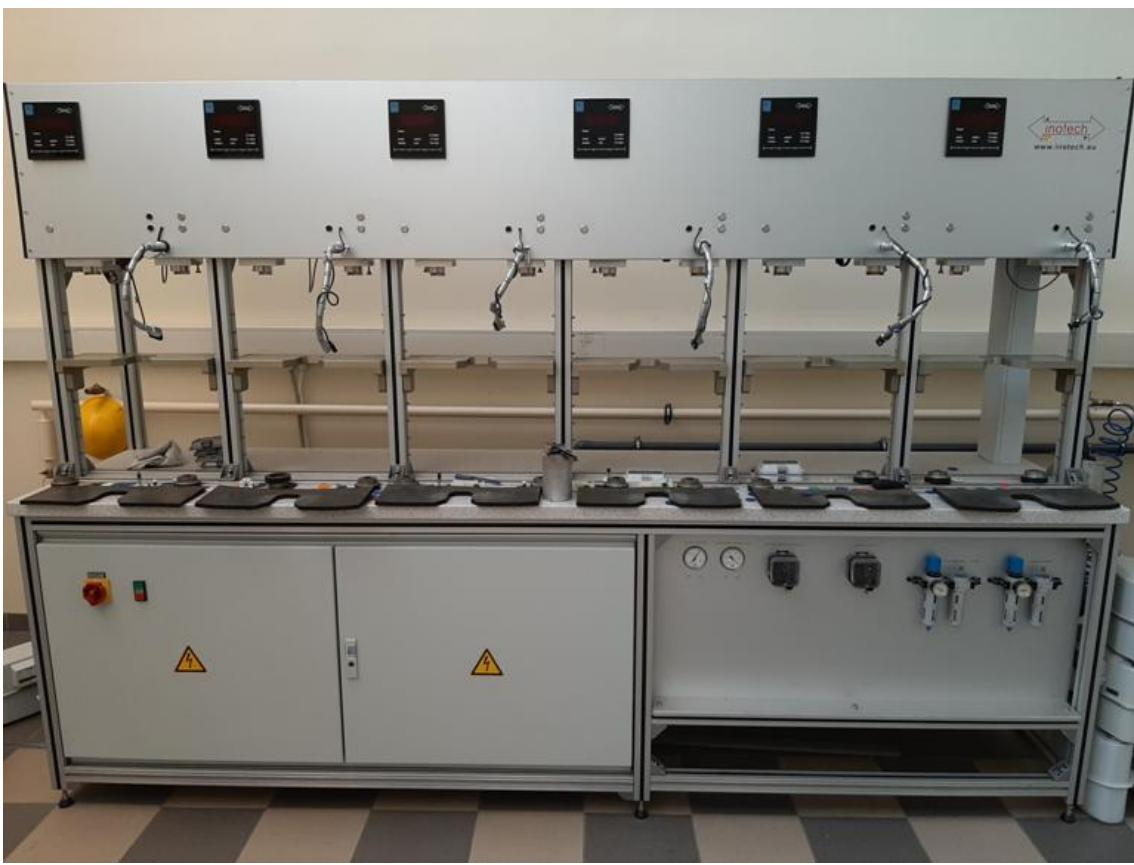
Slika 18. Ispitni uređaj s kritičnim sapnicama- Ispitna linija 1 (fotografirano 30.6.2021.)
