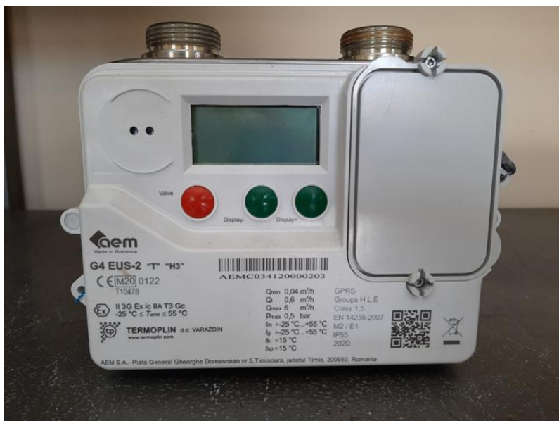
Slika 8. Ultrazvučni plinomjer G4 EUS-2 (fotografirano 3.8.2021.)
