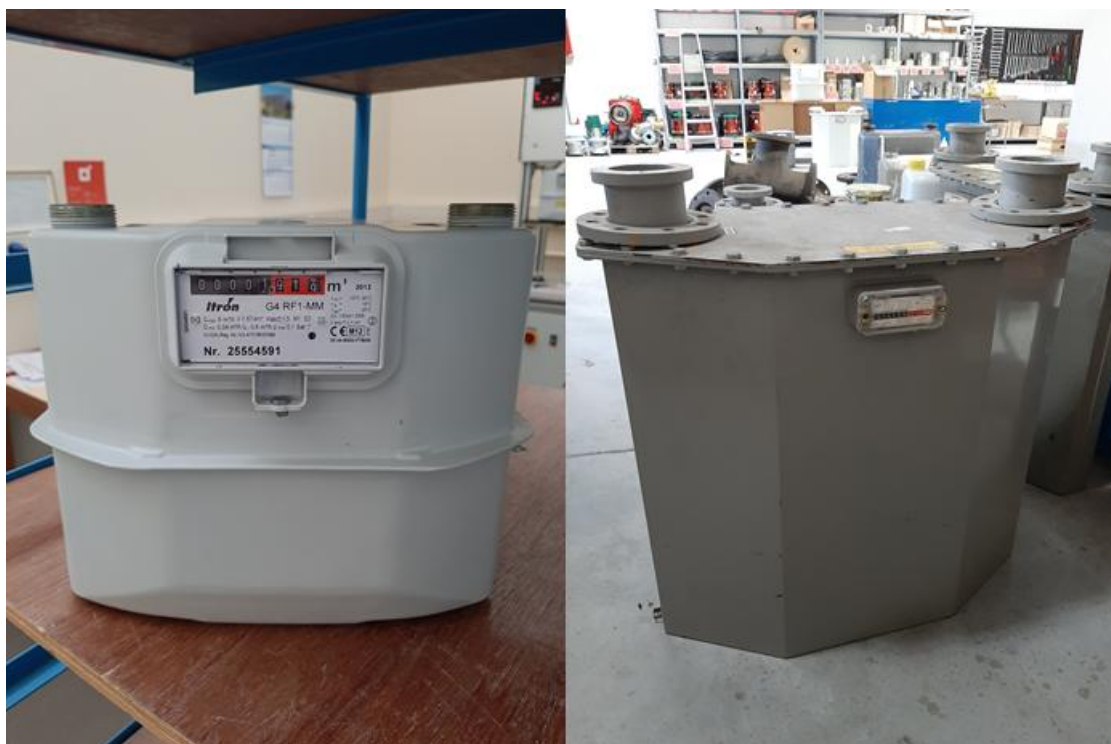
Slika 6. Plinomjeri na mijeh – G4 i G100 (fotografirano 3.8.2021.)
