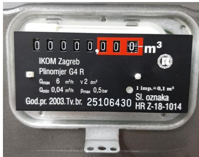
Slika 21. Natpisna pločica G4 plinomjera (fotografirano 27.8.2021.)
