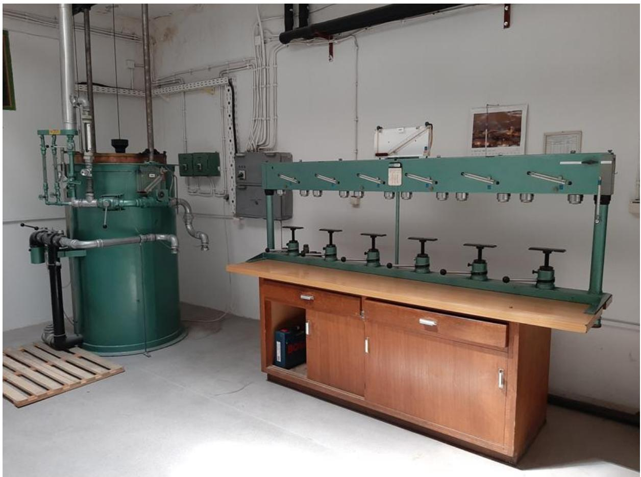
*Slika 17. Uredaj sa zvonom za ispitivanje plinomjera (fotografirano 30.6.2021.)*
