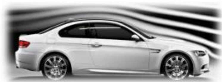
Slika 5.1. Ispitivanje aerodinamičnosti automobila u zračnom tunelu.
