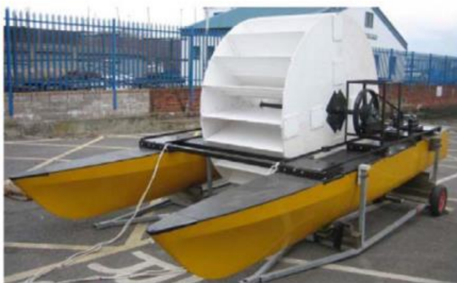
Slika 3.4. Vodenica za proizvodnju električne energije [9]
