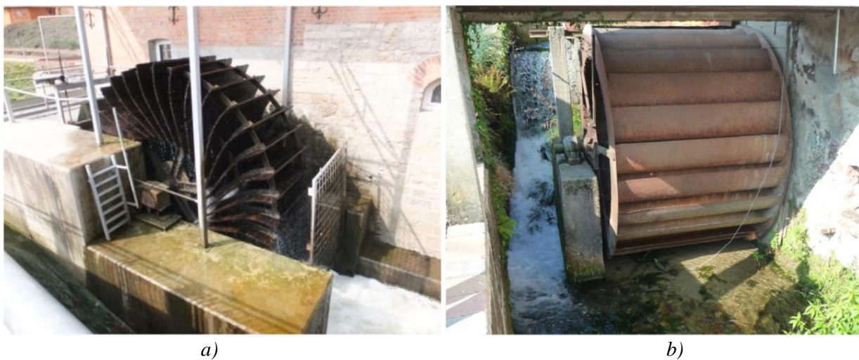
Slika 3.2. Gravitacijska vodna kola: a) Podljevno vodno kolo (preuzeto iz [9]); b) Nadljevno vodno kolo [10]
