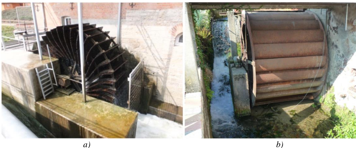
Slika 3.2. Gravitacijska vodna kola: a) Podljevno vodno kolo (preuzeto iz [9]); b) Nadljevno vodno kolo [10]
