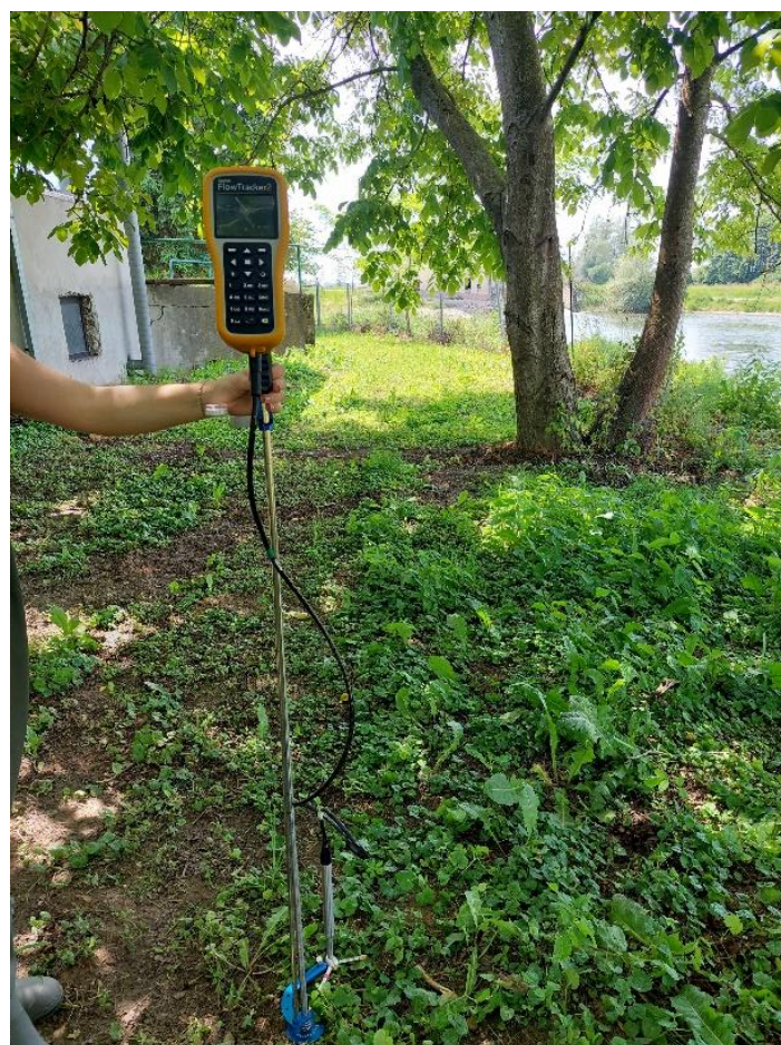
Slika 4.9. Uređaj FlowTracker2 spreman za rad
