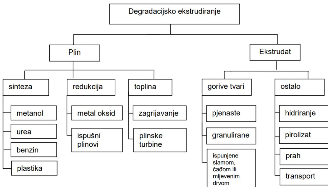
Slika 5. Primjena degradacijskog ekstrudiranja tokom recikliranja [9]
