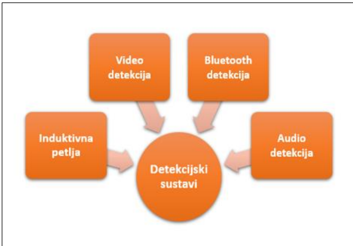
Slika 5.1. Detekcijski sustavi u inteligentnim prometnim sustavima
