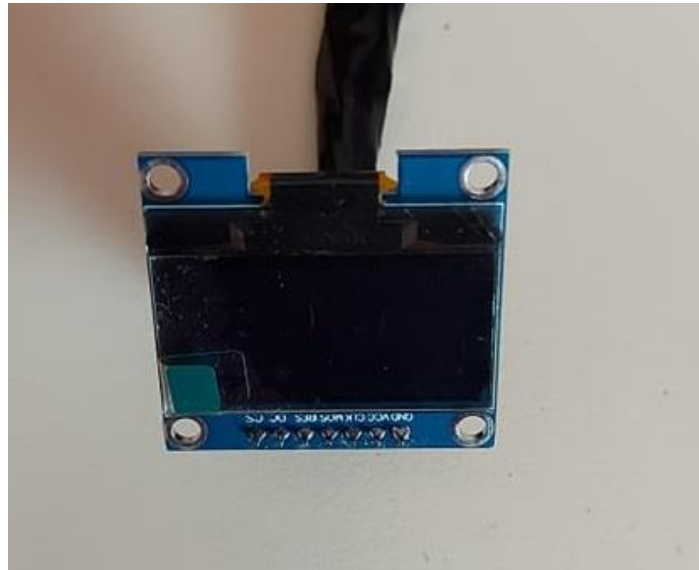
Slika 3.7: OLED 128x64 ekran
