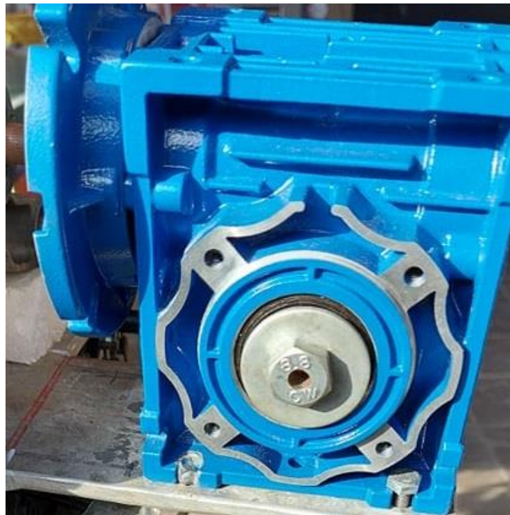
Slika 3.9: Reduktor sa omjerom redukcije 1:5
