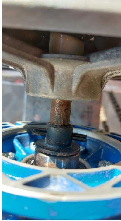
Slika 3.18: Spojnica reduktora i motora
