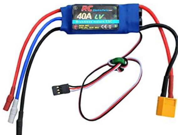
Slika 2.18: ESC za BLDC motore [12]
