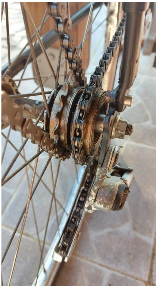
Slika 3.16: Dvostruki free wheel lančanici
