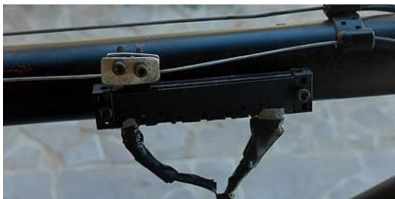
Slika 3.17: Potenciometar za regulaciju brzine vrtinje
