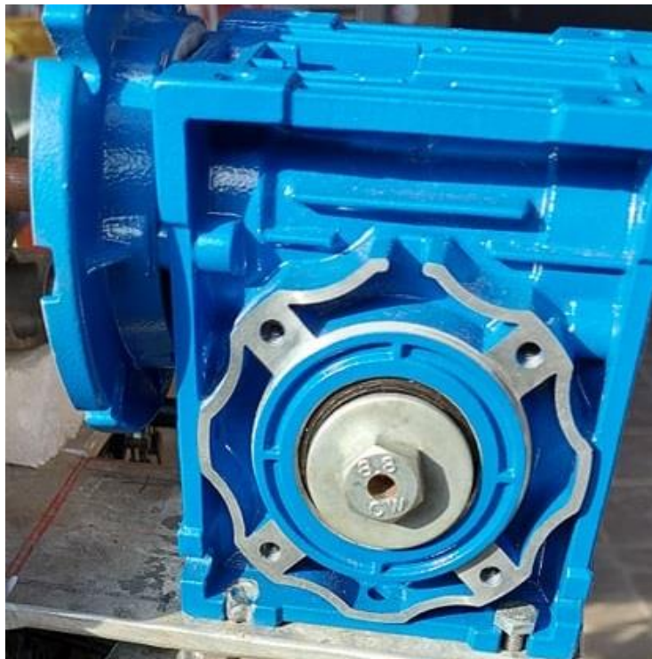
Slika 3.9: Reduktor sa omjerom redukcije 1:5
