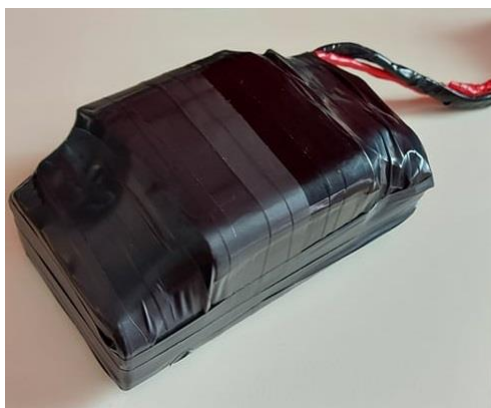
Slika 3.3: Baterija od 36 V za napajanje uzbuđenog namota
