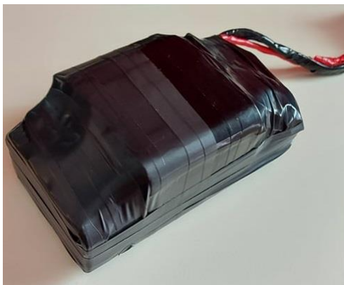
Slika 3.3: Baterija od 36 V za napajanje uzbuđenog namota
