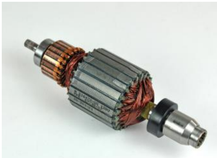
Slika 2.6: Unutrašnjost DC motora sa četkicama [9]
