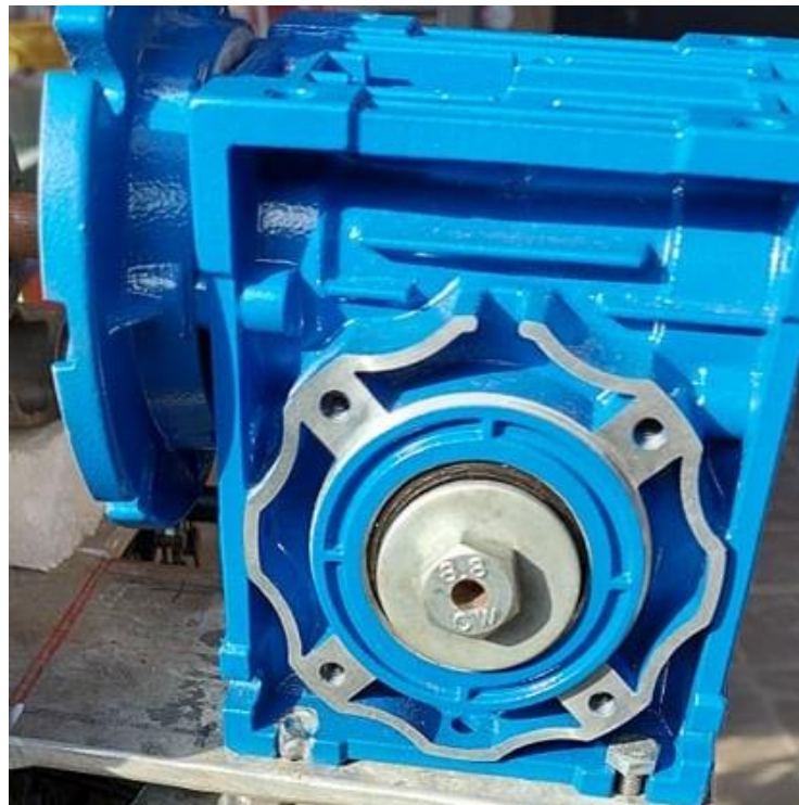
Slika 3.9: Reduktor sa omjerom redukcije 1:5
