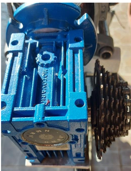
Slika 3.19: Spojnica reduktora i pogonskog lančanika
