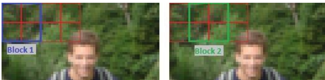
Slika 2.7. Pomicanje normalizacijskog bloka ćelija (izvor: http://mccormickml.com/2013/05/09/hog-person-detector-tutorial/ )
