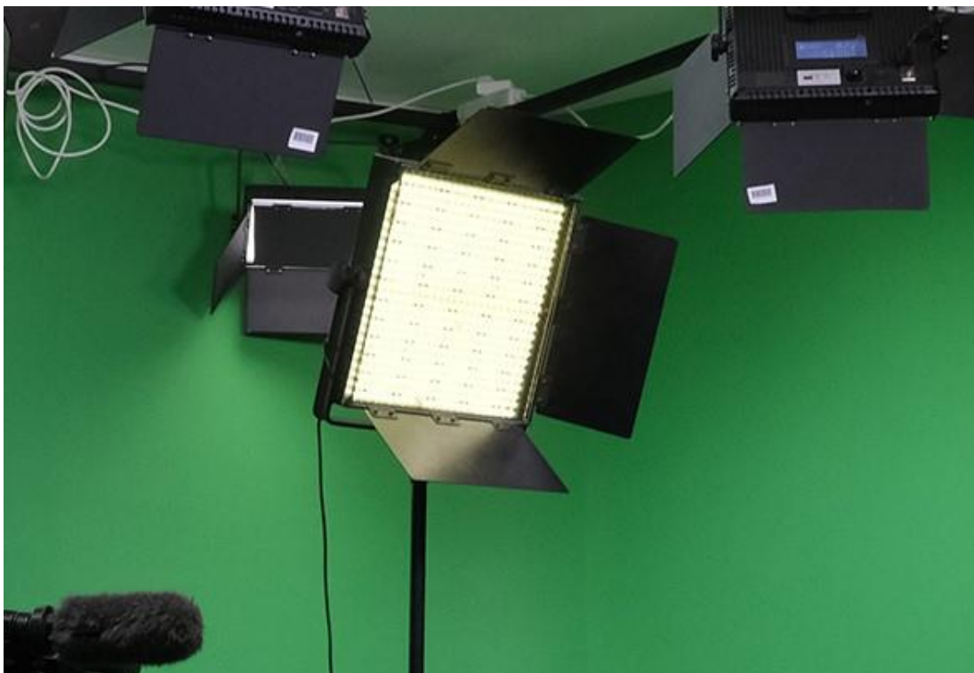
Slika 4.7. – Vrata za kontrolu svjetla reflektora
