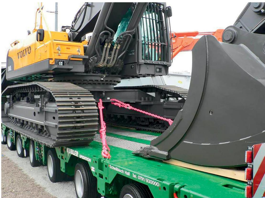
Slika 3: Primjer ispravnog dijagonalnog povezivanja stroja na labudici
