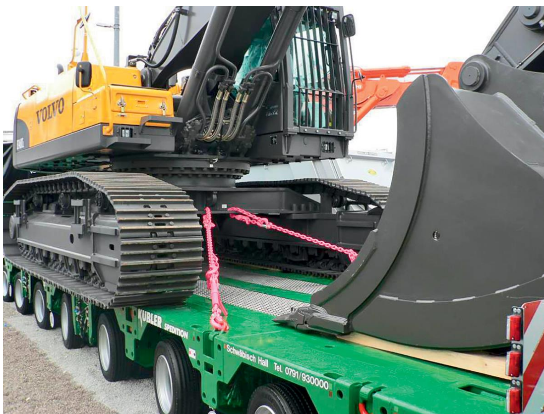
Slika 3: Primjer ispravnog dijagonalnog povezivanja stroja na labudici
