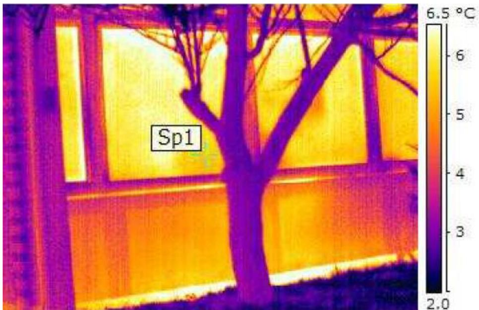
Slika 8. Toplinski most na spoju zidne i podne konstrukcije [9]
