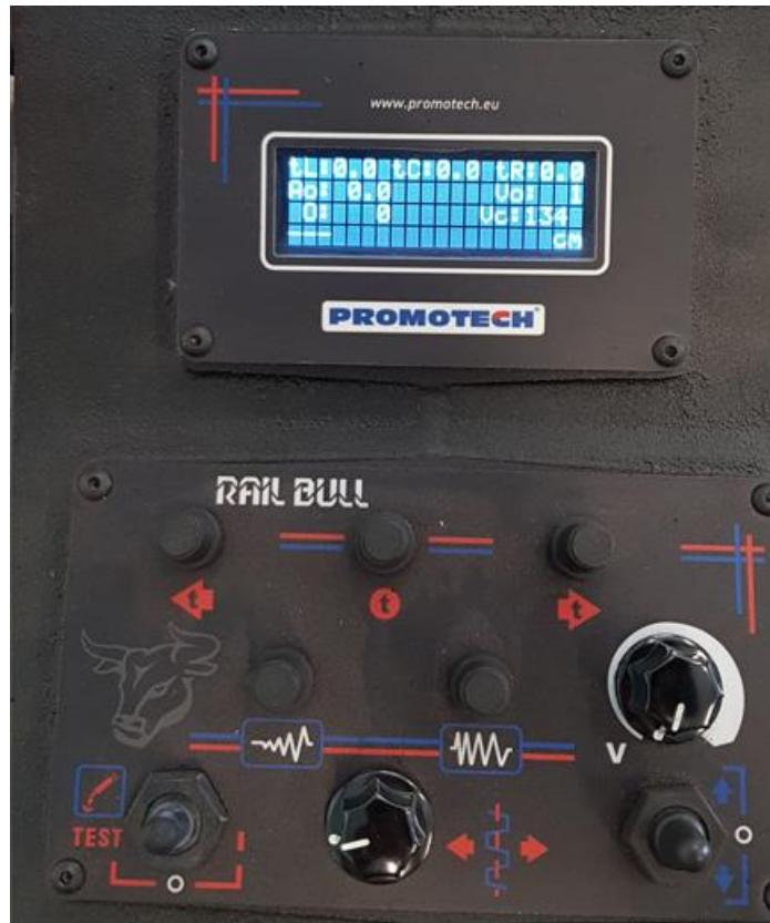
Slika 42. Prikaz kontrolne ploče Rail Bull automata
