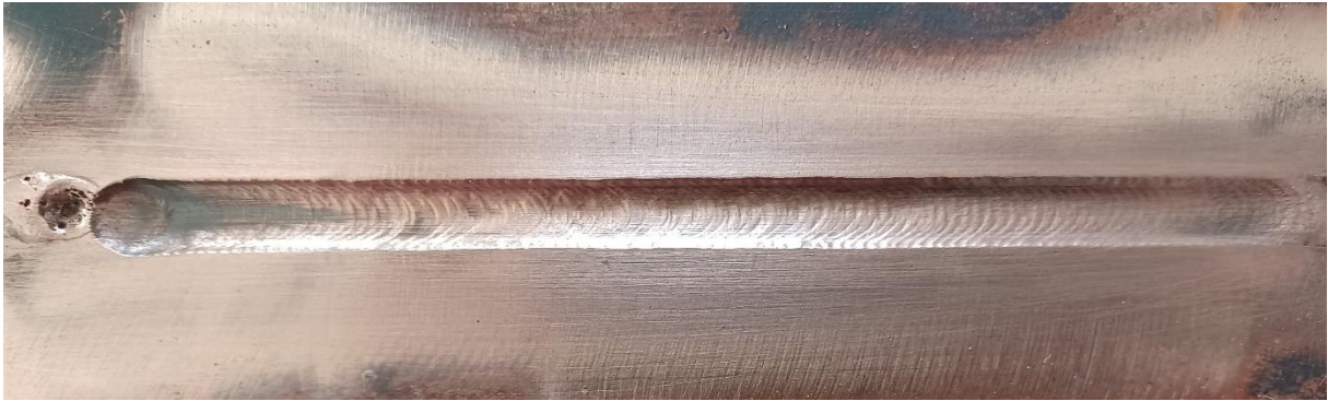
Slika 44. Lice zavora prvog uzorka
