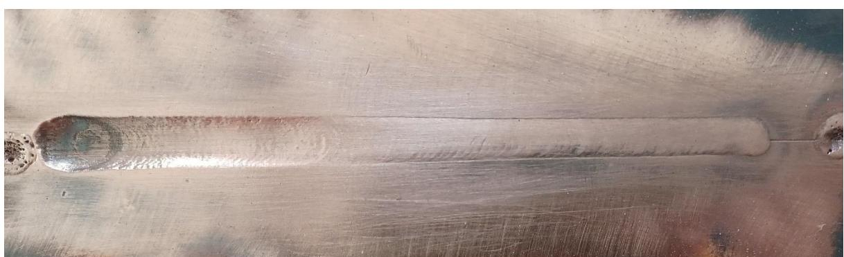
*Slika 46. Lice zavara trećeg uzorka*
