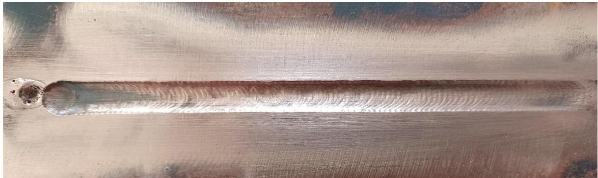
*Slika 44. Lice zavara prvog uzorka*
