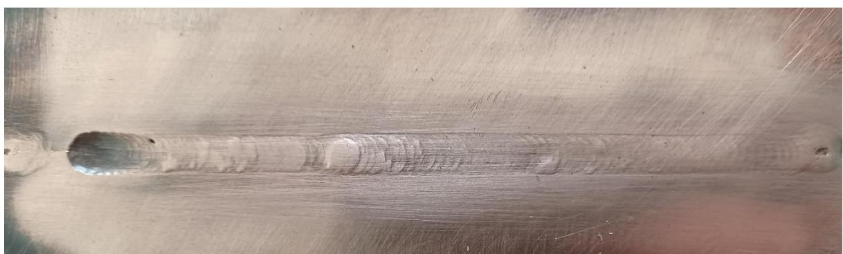
*Slika 45. Lice zavara drugog uzorka*
