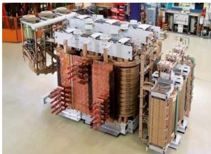
Slika 5. Korištenje bakra kod namotaja transformatora
