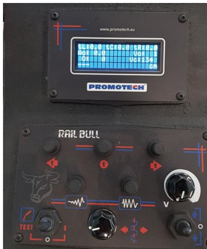
Slika 42. Prikaz kontrolne ploče Rail Bull automata
