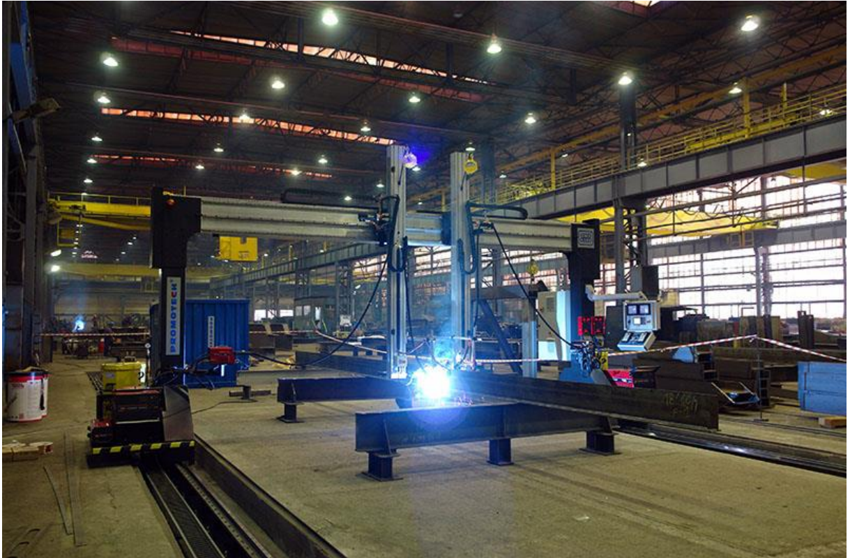
Slika 26. Promotech GWS sustav zavarivanja [21]
