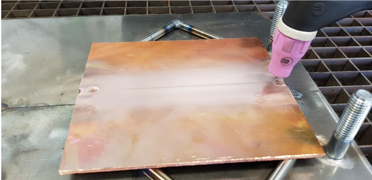
Slika 43. Pozicioniran uzorak ispod elektrode
