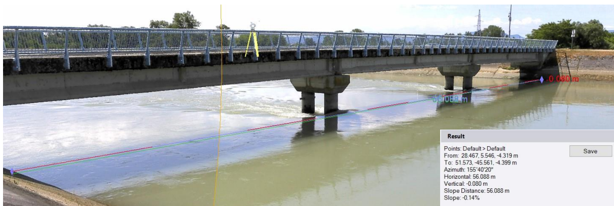
Slika 29. Uzdužni presjek mosta Družbinec iz 3D modela
