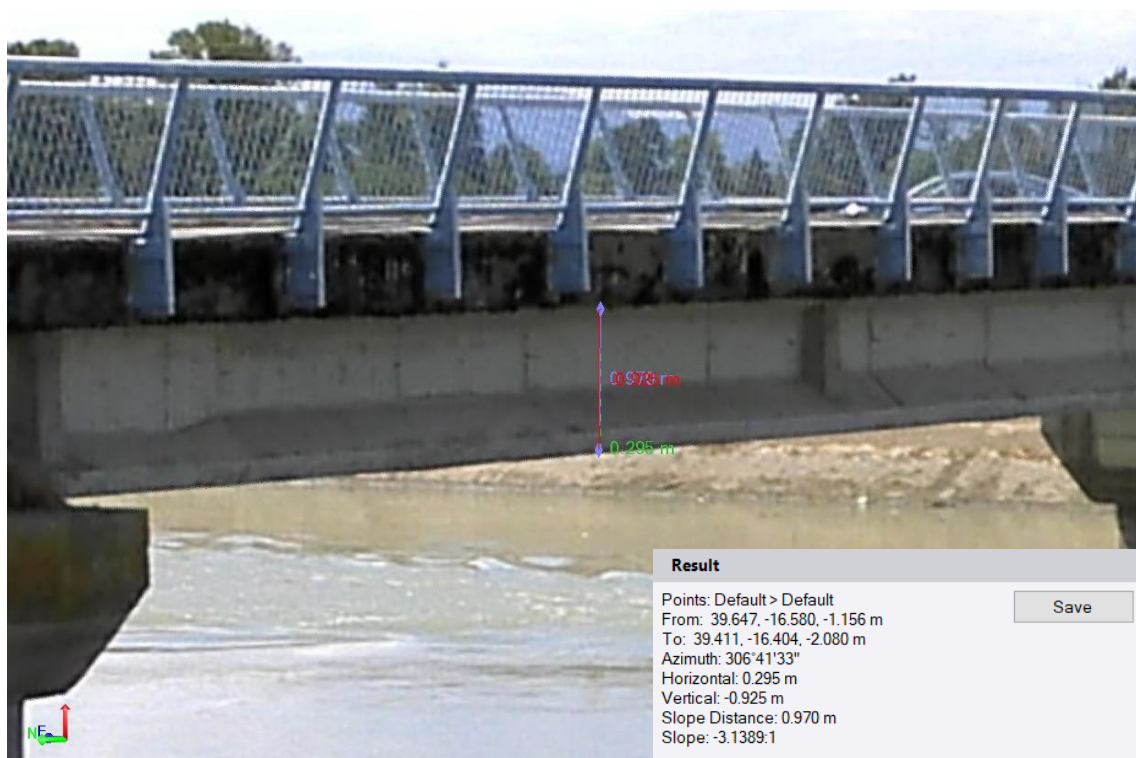
Slika 30. Očitavanje dimenzija iz 3D modela
