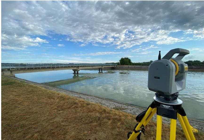
Slika 11. 3D Skeniranje mosta „Družbinec“[19]
