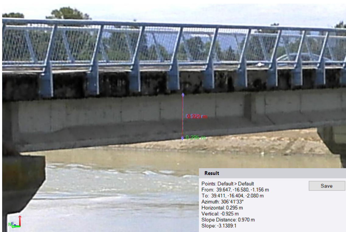
Slika 30. Očitavanje dimenzija iz 3D modela
