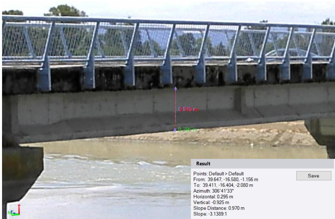
Slika 30. Očitavanje dimenzija iz 3D modela
