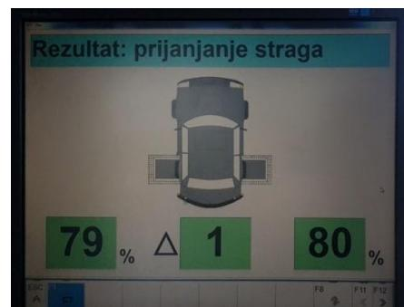
Slika 37b. Stupanj prigušenja amortizera stražnje osovine (fotografirano 17.06.2021.)
