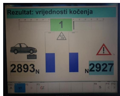
Slika 40b. Kočne sile na prednjoj osovini (fotografirano 17.06.2021.)
