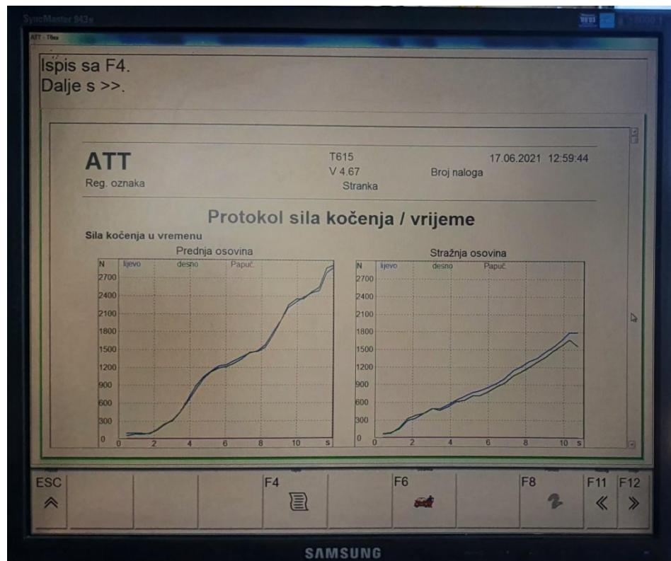
Slika 45. Dijagrami sile kočenja radne kočnice (fotografirano 17.06.2021.)
