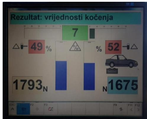
Slika 41b. Kočne sile na stražnjoj osovini
