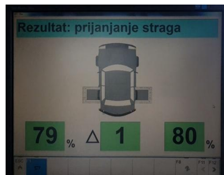
Slika 37b. Stupanj prigušenja amortizera stražnje osovine (fotografirano 17.06.2021.)
