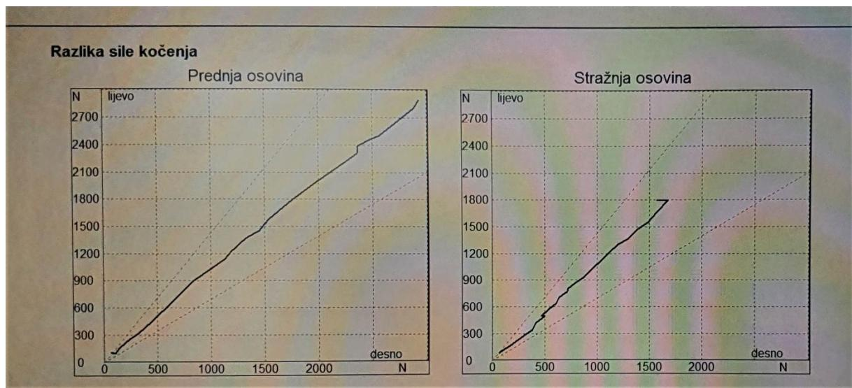
Slika 46. Dijagrami razlike sile kočenja radne kočnice (fotografirano 17.06.2021.)
