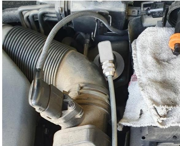
*Slika 25. Mjerna sonda postavljena u ekspanzijski spremnik
