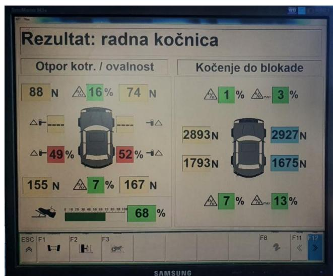
Slika 44. Rezultati ispitivanja radne kočnice (fotografirano 17.06.2021.)
