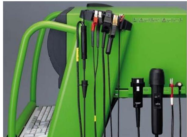
*Slika 18. Mjerni senzori modula DTM [7]*
