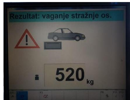
Slika 36b. Masa stražnje osovine (fotografirano 17.06.2021.)
