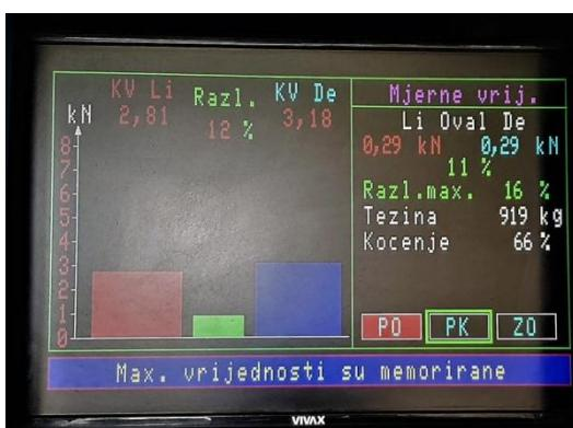
Slika 40a. Kočne sile na prednjoj osovini
