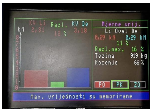
Slika 40a. Kočne sile na prednjoj osovini (fotografirano 10.06.2021.)
