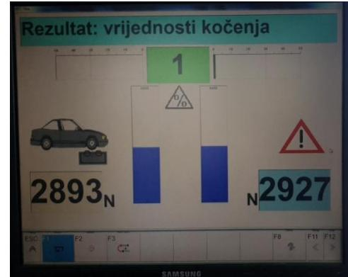
Slika 40b. Kočne sile na prednjoj osovini
