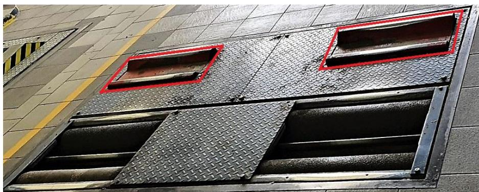
*Slika 32. Uređaj za ispitivanje stupnja prigušenja amortizera (fotografirano 10.06.2021.)*
