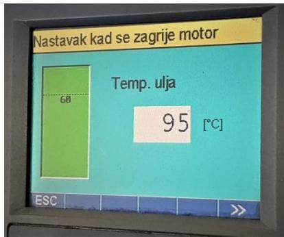
*Slika 6. Temperatura ulja kod zagrijanog motora (fotografirano 17.06.2021.)*
