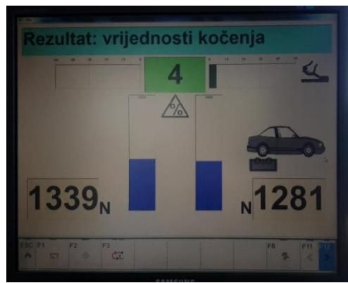
Slika 42b. Kočne sile pomoćne kočnice
