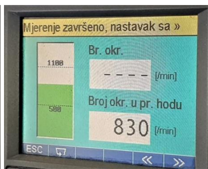
Slika 7. Broj okretaja u praznom hodu motora (fotografirano 17.06.2021.)
