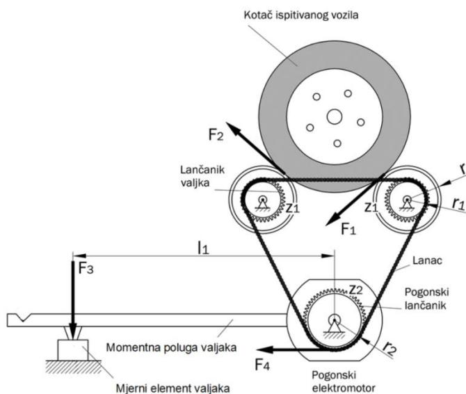
Slika 49. Princip mjerjenja kočne sile [15]
