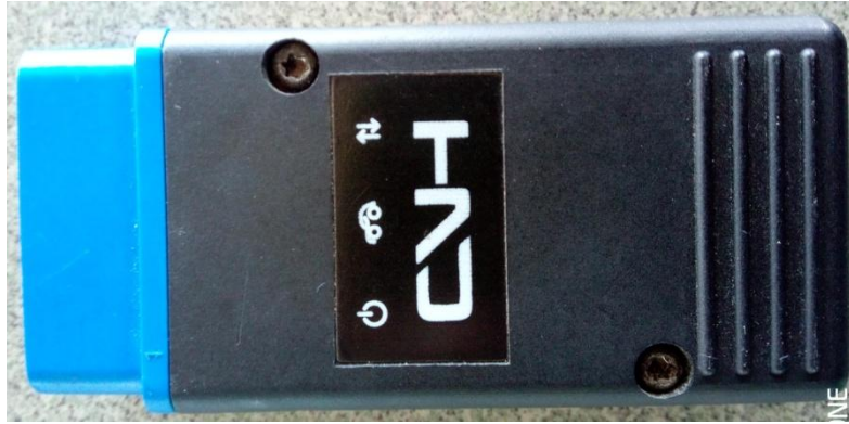
Slika 21. Uređaj za komunikaciju OBD priključnice (fotografirano 17.06.2021.)
