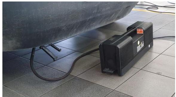
*Slika 10. Mjerna sonda postavljena u ispušnu cijev (fotografirano 17.06.2021.)*
