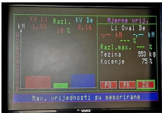
Slika 41a. Kočne sile na stražnjoj osovini
