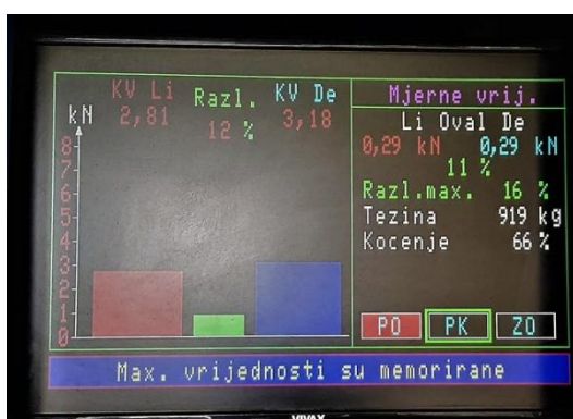
Slika 40a. Kočne sile na prednjoj osovini (fotografirano 10.06.2021.)
