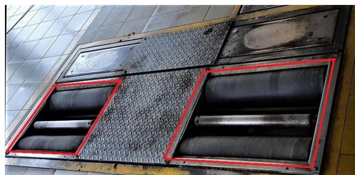
Slika 39. Valjci za mjerjenje kočne sile (fotografirano 10.06.2021.)
