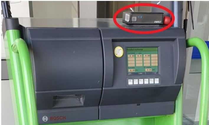
Slika 19. OWR17 uređaj implementiran na Bosch BEA 350 (fotografirano 17.06.2021.)
