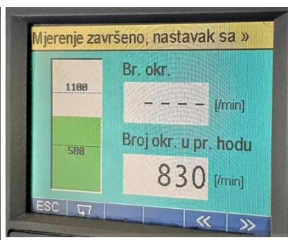
Slika 7. Broj okretaja u praznom hodu motora (fotografirano 17.06.2021.)
