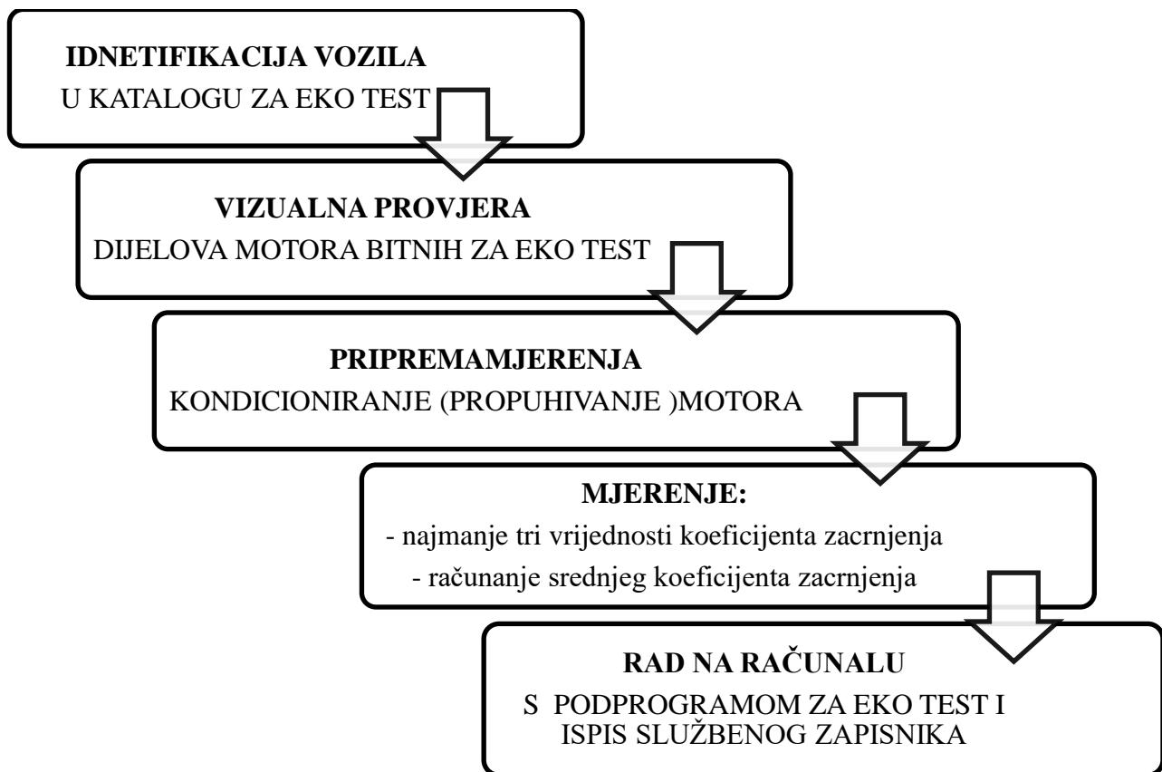
Slika 4. Tijek ispitivanja ispušnih plinova dizelskih motora [7]
