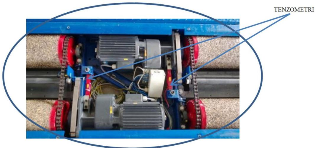
Slika 51. Pogonski elektromotori s garniturom valjaka i tenzometri [13]
