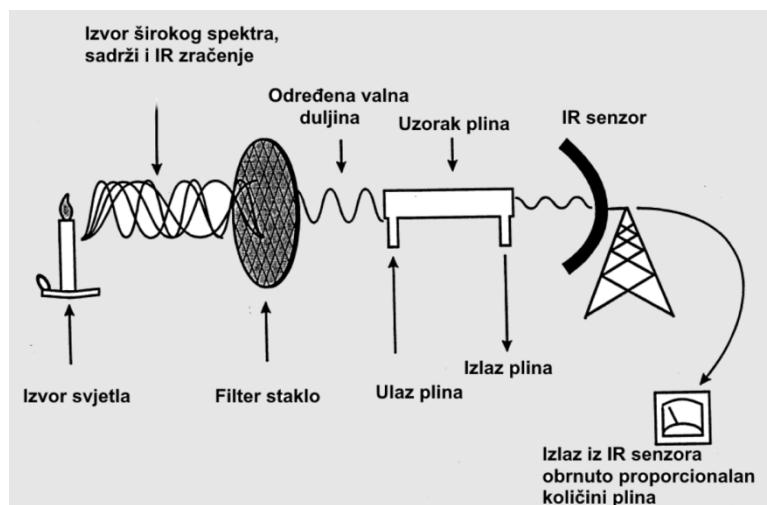
Slika 15. Princip rada analizatora ispušnih plinova [14]
