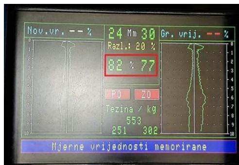
Slika 37a. Stupanj prigušenja amortizera stražnje osovine (fotografirano 10.06.2021.)
