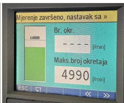
Slika 8. Maksimalni broj okretaja motora (fotografirano 17.06.2021.)
