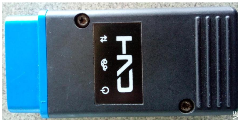
Slika 21. Uređaj za komunikaciju OBD priključnice (fotografirano 17.06.2021.)
