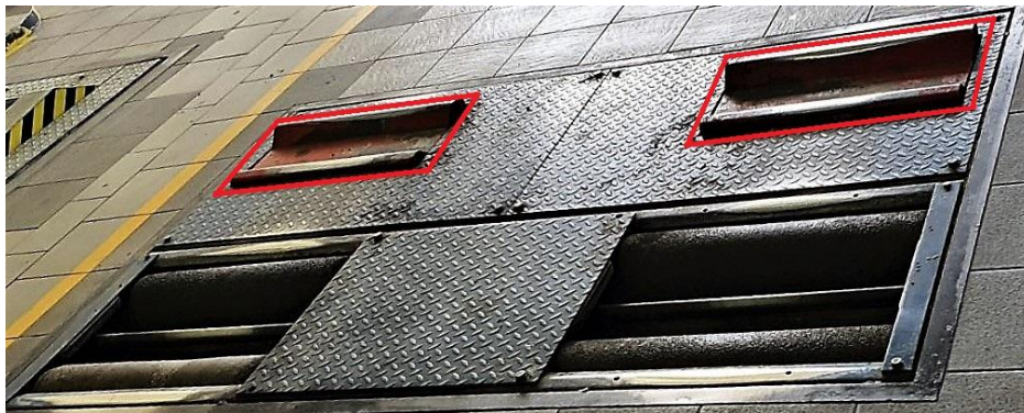
Slika 32. Uređaj za ispitivanje stupnja prigušenja amortizera (fotografirano 10.06.2021.)
