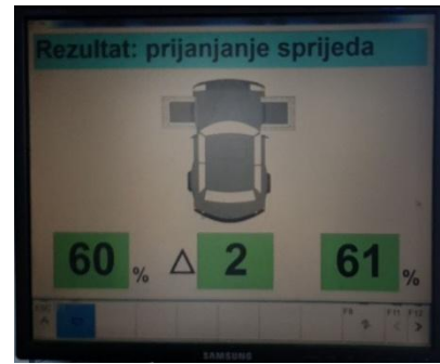
Slika 35b. Stupanj prigušenja amortizera prednje osovine (fotografirano 17.06.2021.)
