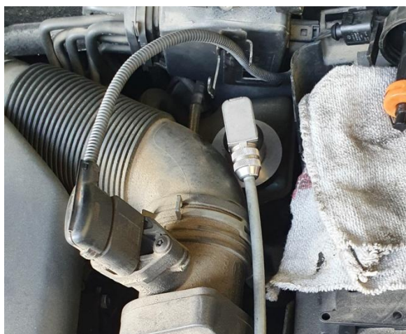
Slika 25. Mjerna sonda postavljena u ekspanzijski spremnik kočne tekućine (fotografirano 10.06.2021.)
