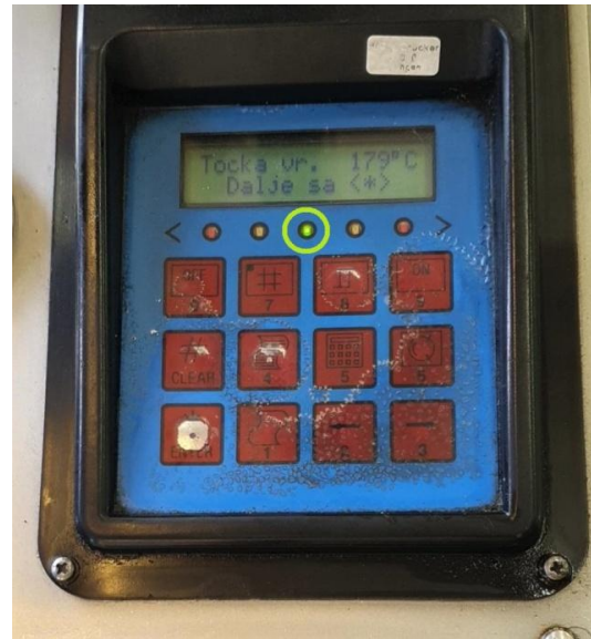
Slika 27. Vrlo dobra kočna tekućina, treperi zelena dioda (fotografirano 10.06.2021.)
