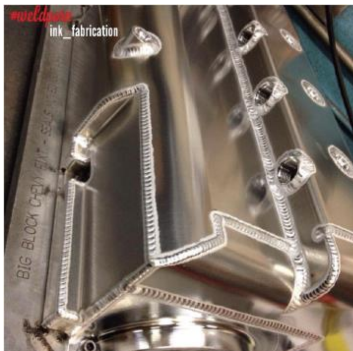
Slika 3.2. Prikaz sloja razbijenog oksida uz zavar [18]
