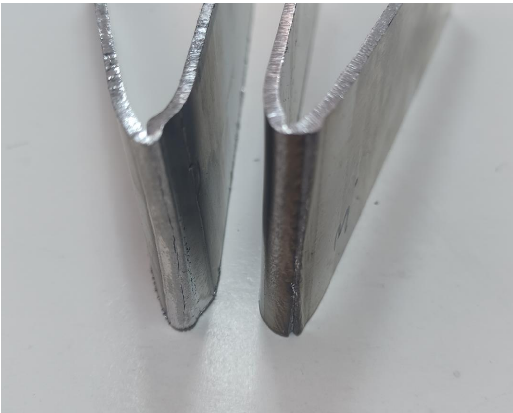
Slika 4.14. Prikaz rezultata ispitivanja savijanjem lica i korijena epruvete 3.
