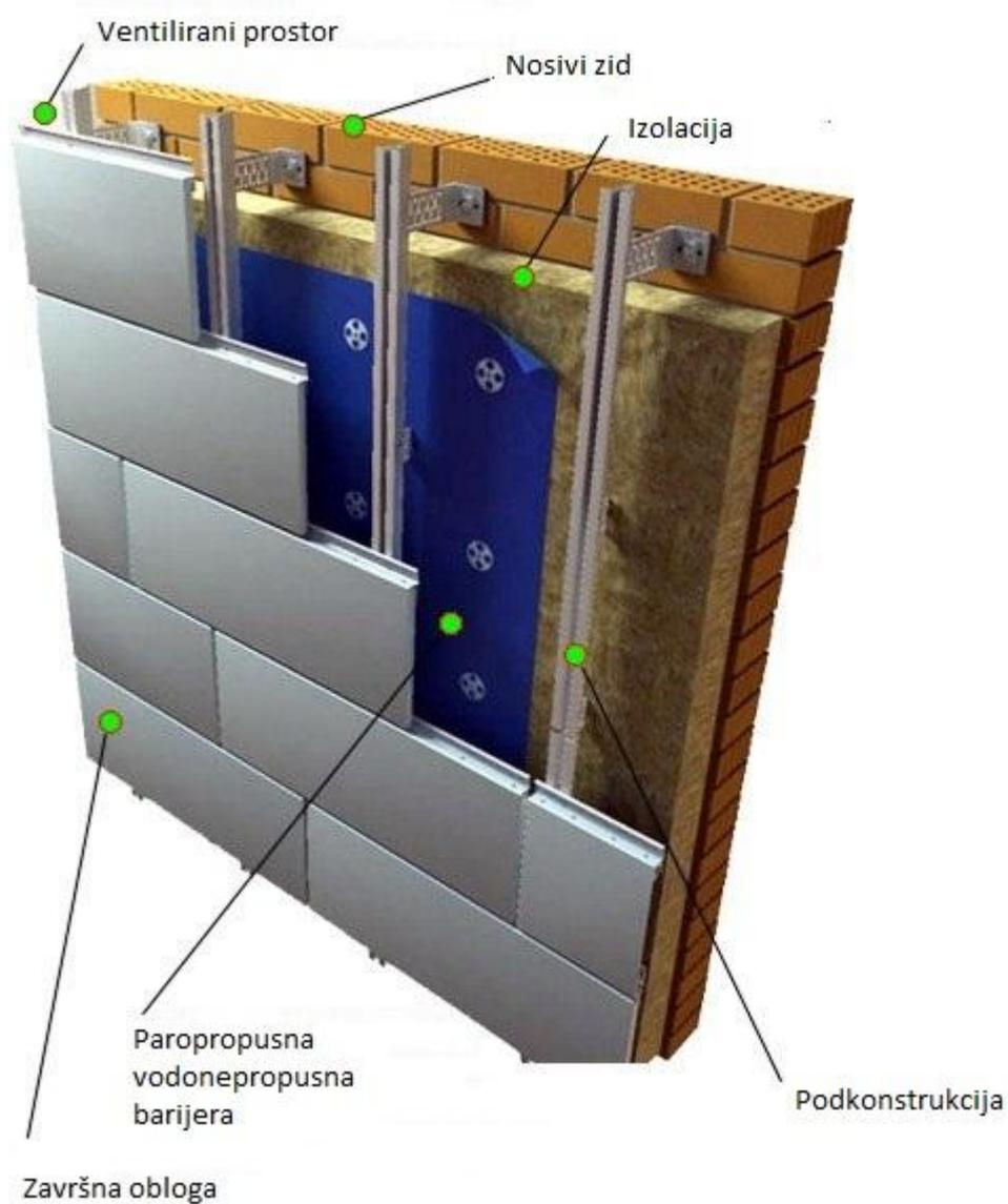
Slika 2.1. Ilustracija konstruktivnih elemenata ventilirane fasade, izvor: <https://fondeco.ru/>
