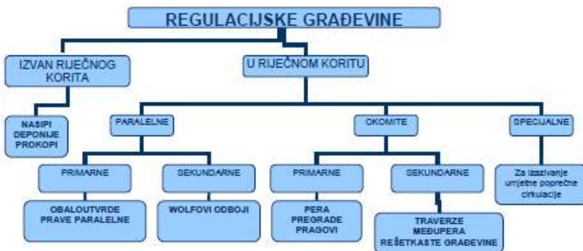
Slika 3.6 Podjela regulacijskih građevina [7]
