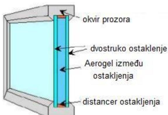
Slika 4.5.1.2 Dvostruko ostakljenje sa aerogelom [24]
