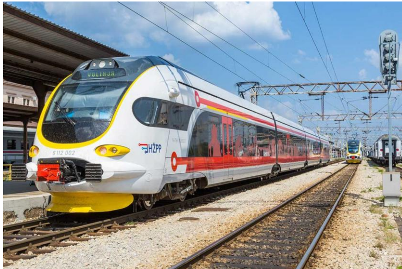
Slika 9. Primjer novijeg putničkog vlaka HŽ-a, Niskopodni dizel-motorni vlak serije 7023 Izvor: https://www.koncar.hr/podrucja-djelovanja/transport/tracnicka-vozila/ (12.08.2021.g.)
