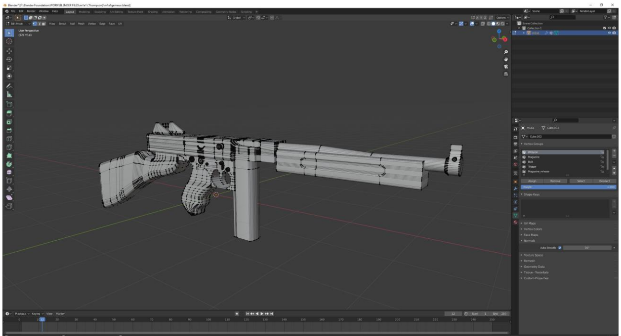
Slika 2.10: Prikaz modela napravljenog po načelima modeliranja s "Quad"-ovima
