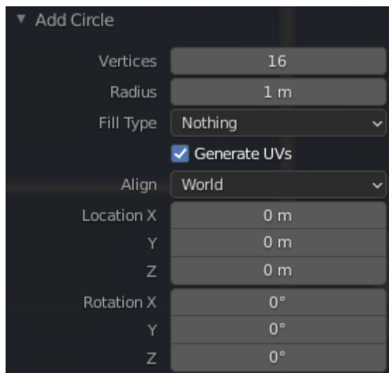
Slika 6.45: Parametri primitivnog oblika „Circle“
