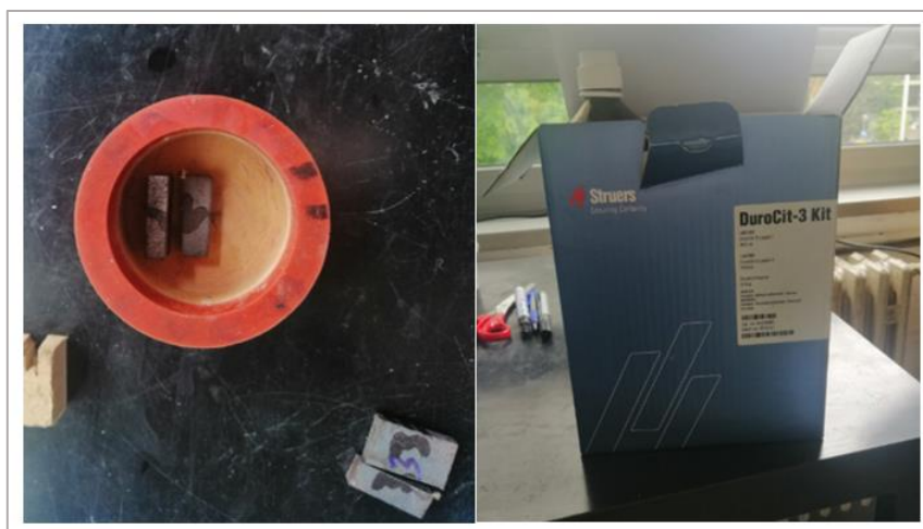
Slika 27. Lijevo - Uzorci položeni u kalup. Desno - Duromer kojim se oblažu.
