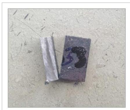
Slika 26. Razrezani uzorak MARAGING čelika.
