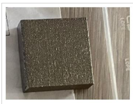
Slika 23. Uzorak MARAGING čelika dobivenog SLM postupkom.
