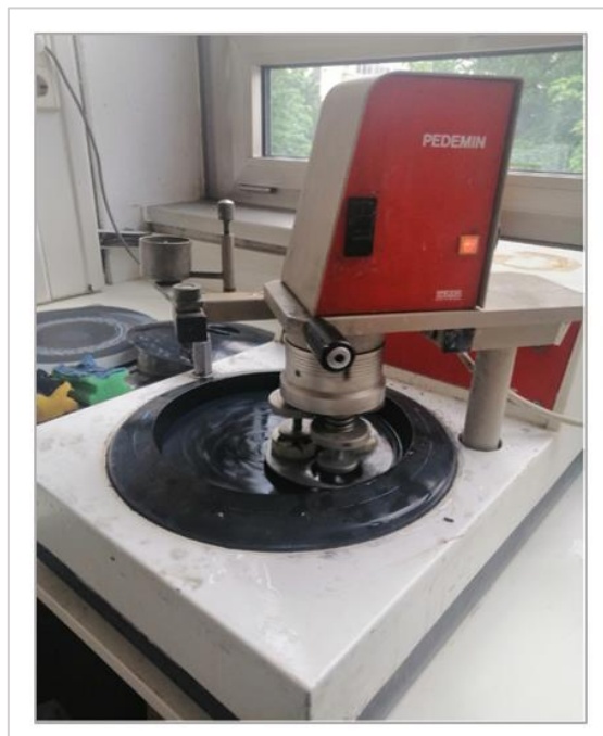
Slika 28. Uređaj za brušenje i poliranje Struers Pedemin.
