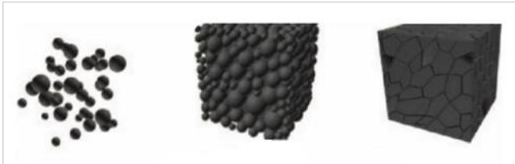
Slika 10. Kompaktiranje i sinteriranje praha. [18]
