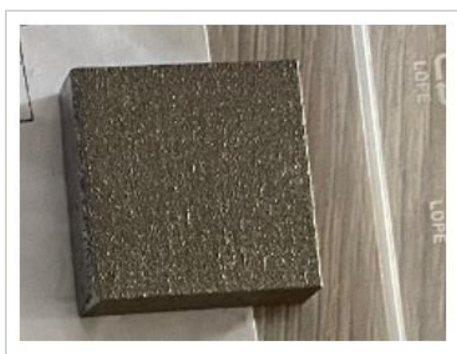
Slika 23. Uzorak MARAGING čelika dobivenog SLM postupkom.
