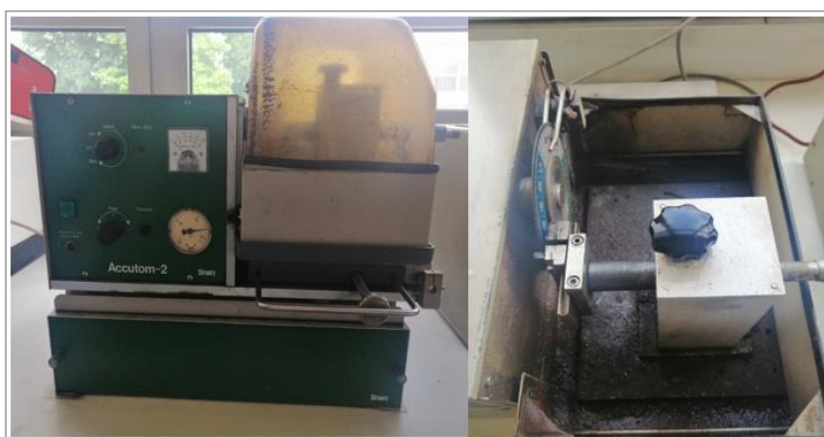
Slika 25. Rezalica Struers Accutom-2.
