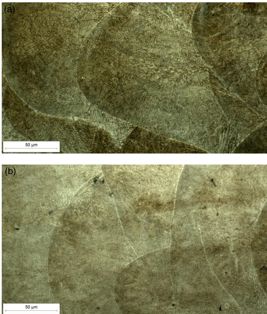
Slika 36. Povećanje 500 x. (a) Uzdužni presjek uzoraka obrađenih dozrijevanjem s debljinom sloja taljenja od 40 \mu\text{m} . (b) Poprečni presjek uzoraka obrađenih dozrijevanjem s debljinom sloja taljenja od 50 \mu\text{m} .
