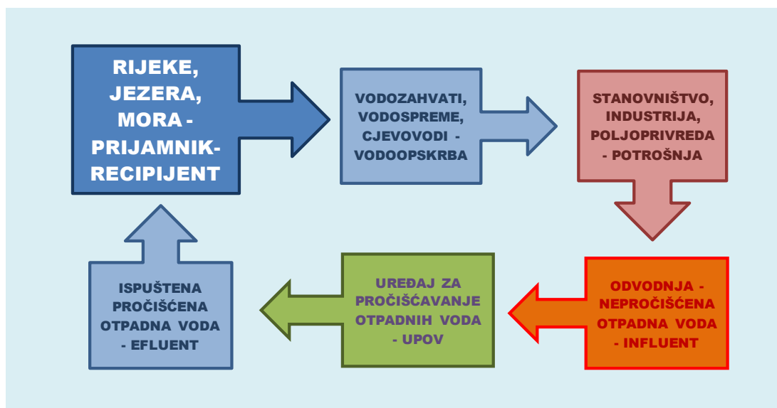
Slika 1.1. Zahvaćanje i ispuštanje vode
