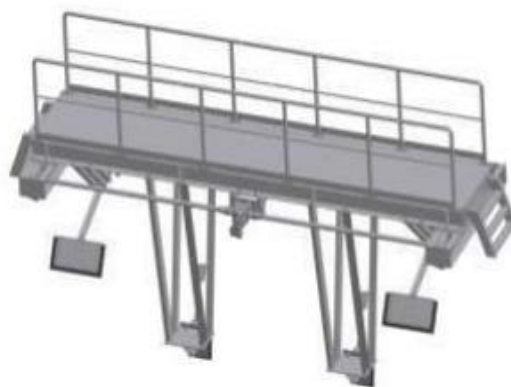
Slika 4.7. Primjer aeriranog pjeskolova-mastolova i pokretnog mosta sa zgrtačima pijeska i masti za dvije linije [12]
