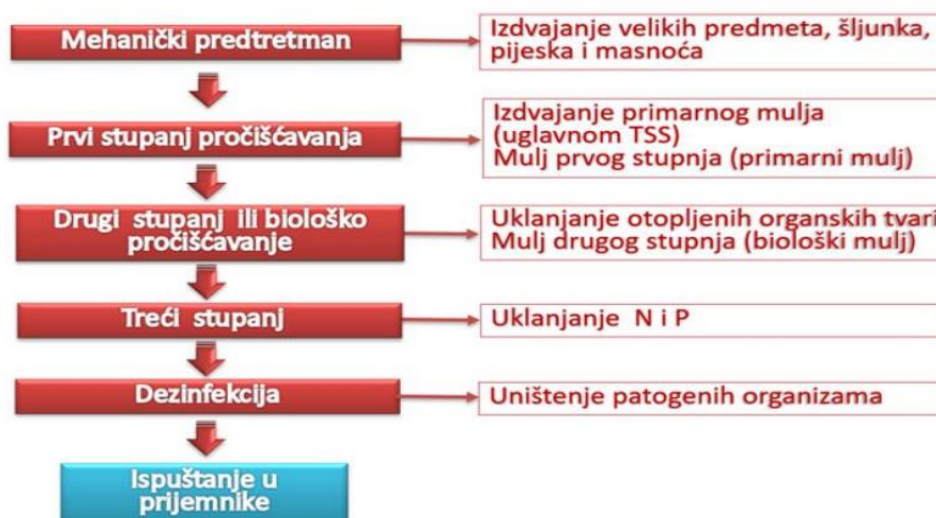
Slika 1.2. Stupnjevi i postupci pročišćavanja [2]
