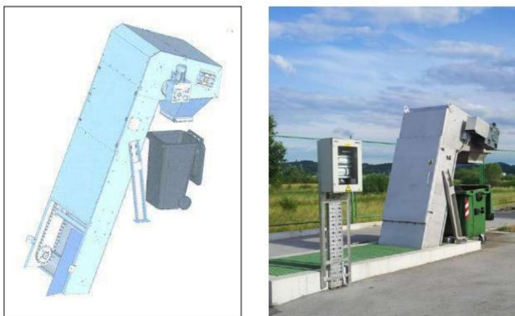
Slika 4.3. Primjer automatske grube rešetke [12]
