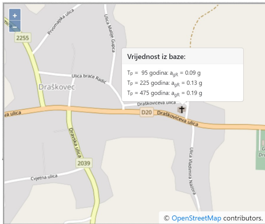
Slika 5.5. Iznosi horizontalnih vršnih ubrzanja tla tipa A ( a_{gR} ) za povratna razdoblja od T_p = 95 i 475 godina izraženih u jedinicama gravitacijskog ubrzanja ( 1 g = 9.81 \text{ m/s}^2 ) – Izvor: http://seizkarta.gfz.hr/karta.php
