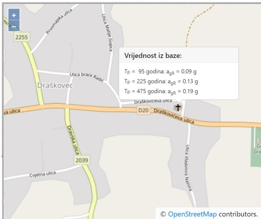
Slika 5.5. Iznosi horizontalnih vršnih ubrzanja tla tipa A ( $a_{gR}$ ) za povratna razdoblja od  $T_p = 95$  i 475 godina izraženih u jedinicama gravitacijskog ubrzanja ( $1 g = 9.81 \text{ m/s}^2$ ) – Izvor: <http://seizkarta.gfz.hr/karta.php>
