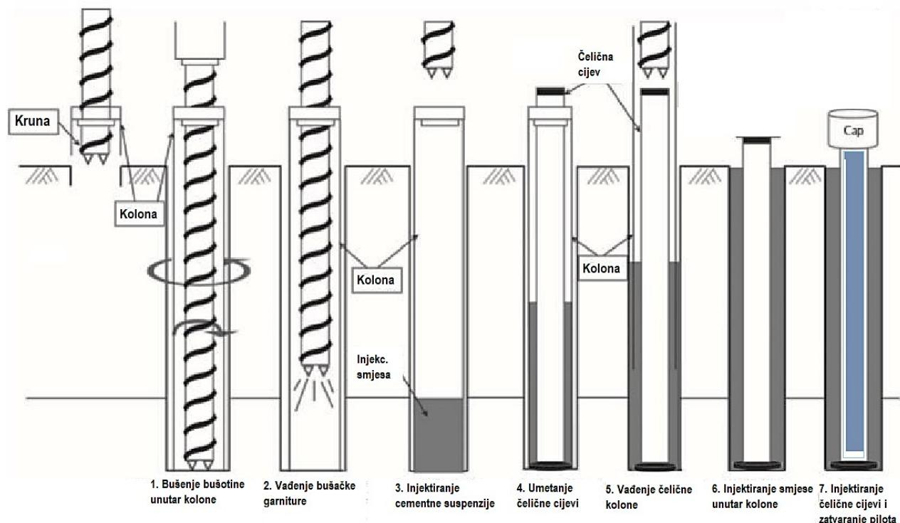
8.4. Shematski prikaz procesa postavljanja čeličnih pilota
