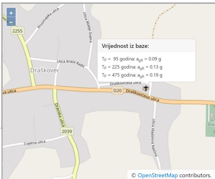
Iznosi horizontalnih vršnih ubrzanja tla tipa A ( $a_{gR}$ ) za povratna razdoblja od  $T_p = 95$  i  $475$  godina izraženih u jedinicama gravitacijskog ubrzanja ( $1 \text{ g} = 9.81 \text{ m/s}^2$ ) – Izvor:
