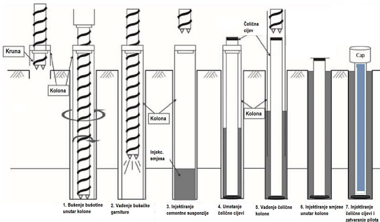
Slika 9.3.Shematski prikaz procesa postavljanja čeličnih pilota
