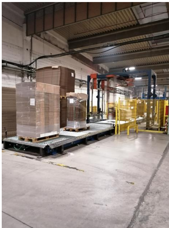
Slika 8: Strojno omatanje folijom
