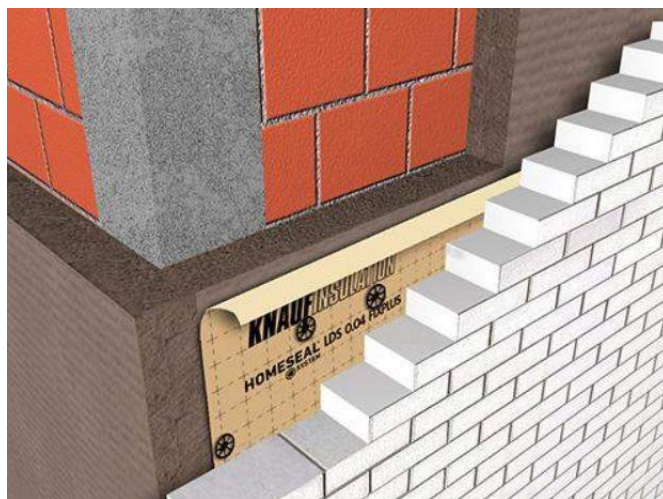
Slika 8. Fasadna opeka kao dupli termo zid [13]
