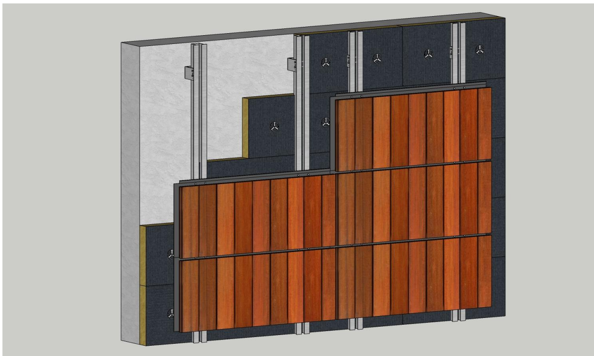
Slika 43. Model 5.HPL ploče – imitacija drvo [18]
