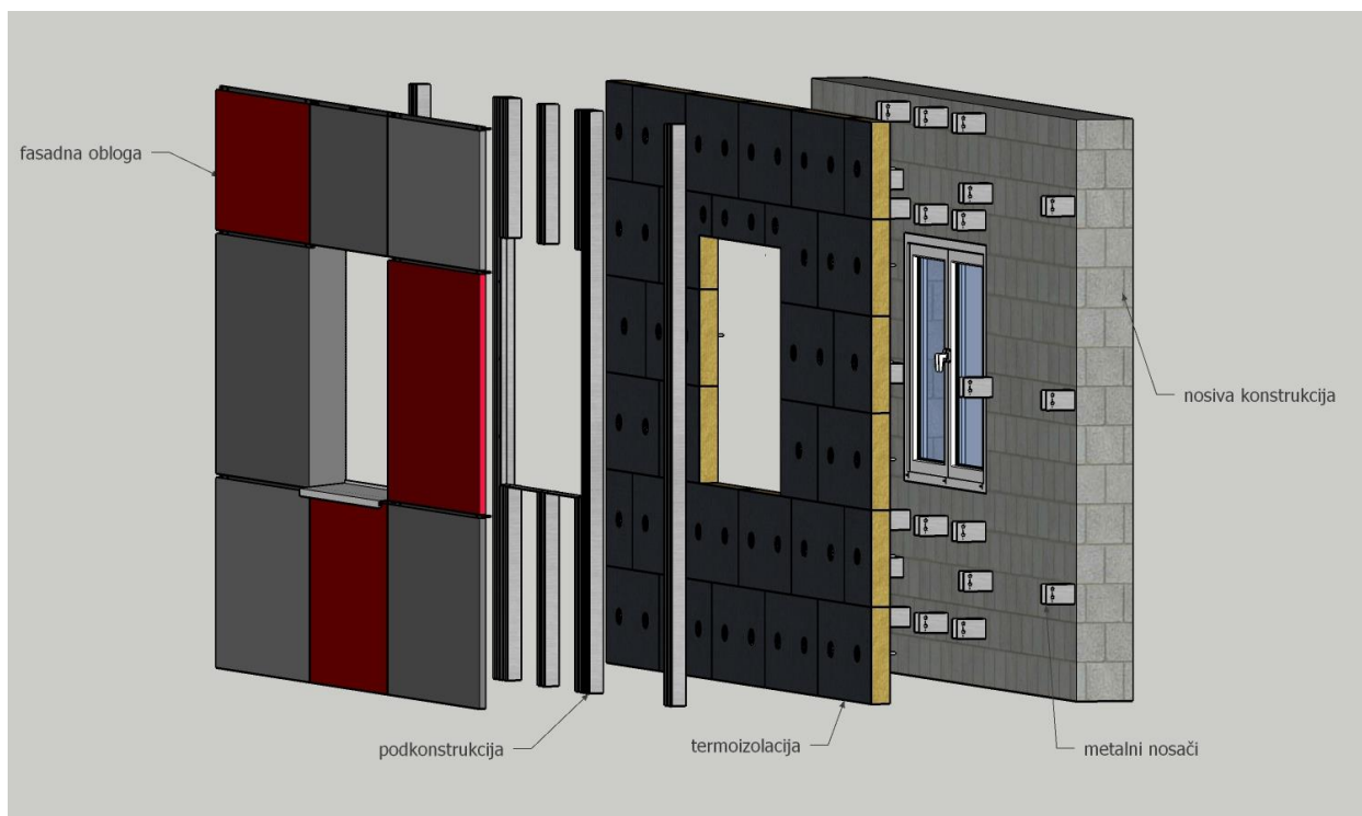
Slika 12. Prikaz dijelova ventilirane fasade [18]
