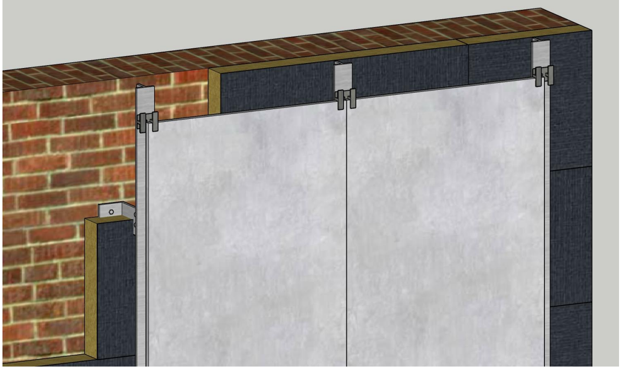
Slika 20. Sistem s vidljivim držačima [18]
