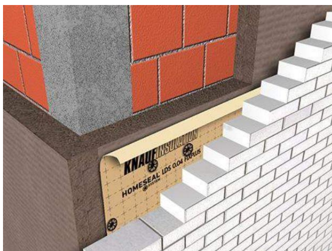
Slika 8. Fasadna opeka kao dupli termo zid [13]
