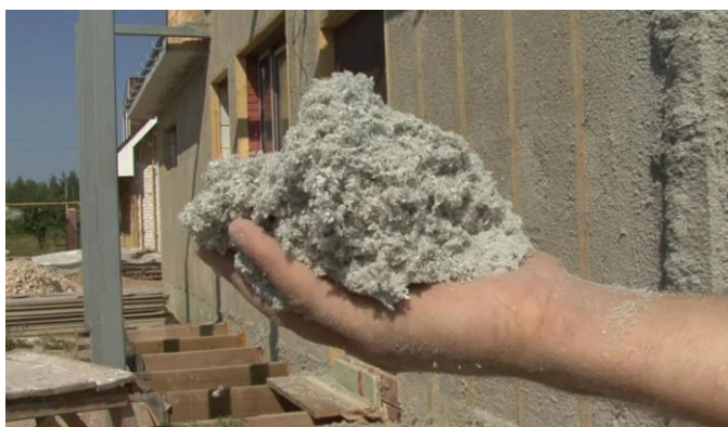
Slika 5. Izolacija celuloznom vunom [9]
